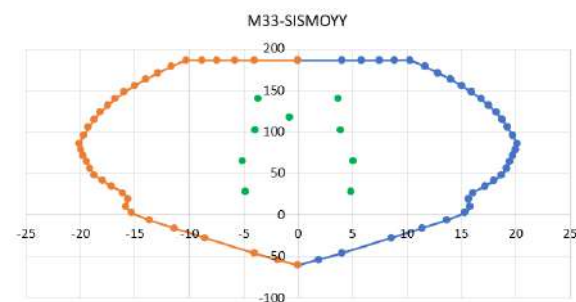
Figura 87. Comprobación del diagrama de interacción columna ejes C1 (III)
