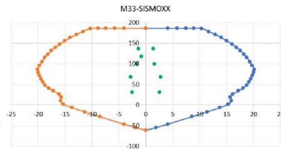
Figura 85. Comprobación del diagrama de interacción columna ejes C1 (I)
