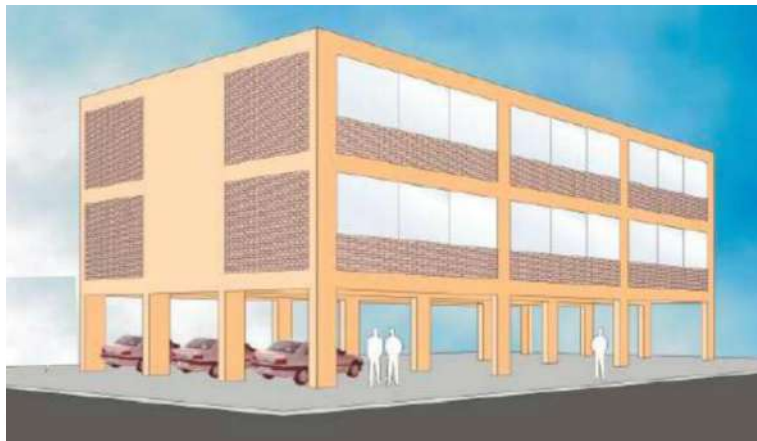
Figura 9. Irregularidad de resistencia. Fuente: Documentos del curso Ingeniería Sismorresistente ~ A. Muñoz
