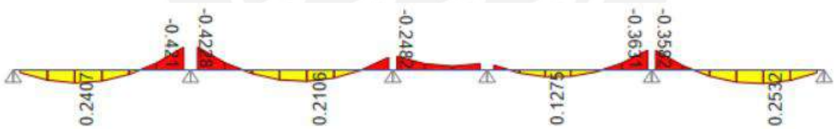
Figura 48. Diagrama de momento flector aligerado
