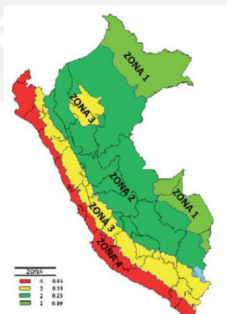
Figura 4. Mapa de zonificación sísmica del Perú. Tomado de la Norma Técnica E.030, por MVCS, 2018
