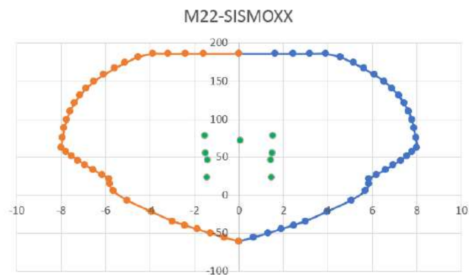
Figura 90. Comprobación del diagrama de interacción columna ejes F4 (II)
