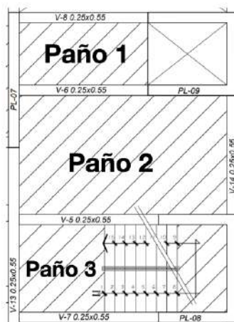
Figura 55. Separación de paños para análisis por Kalmanok
