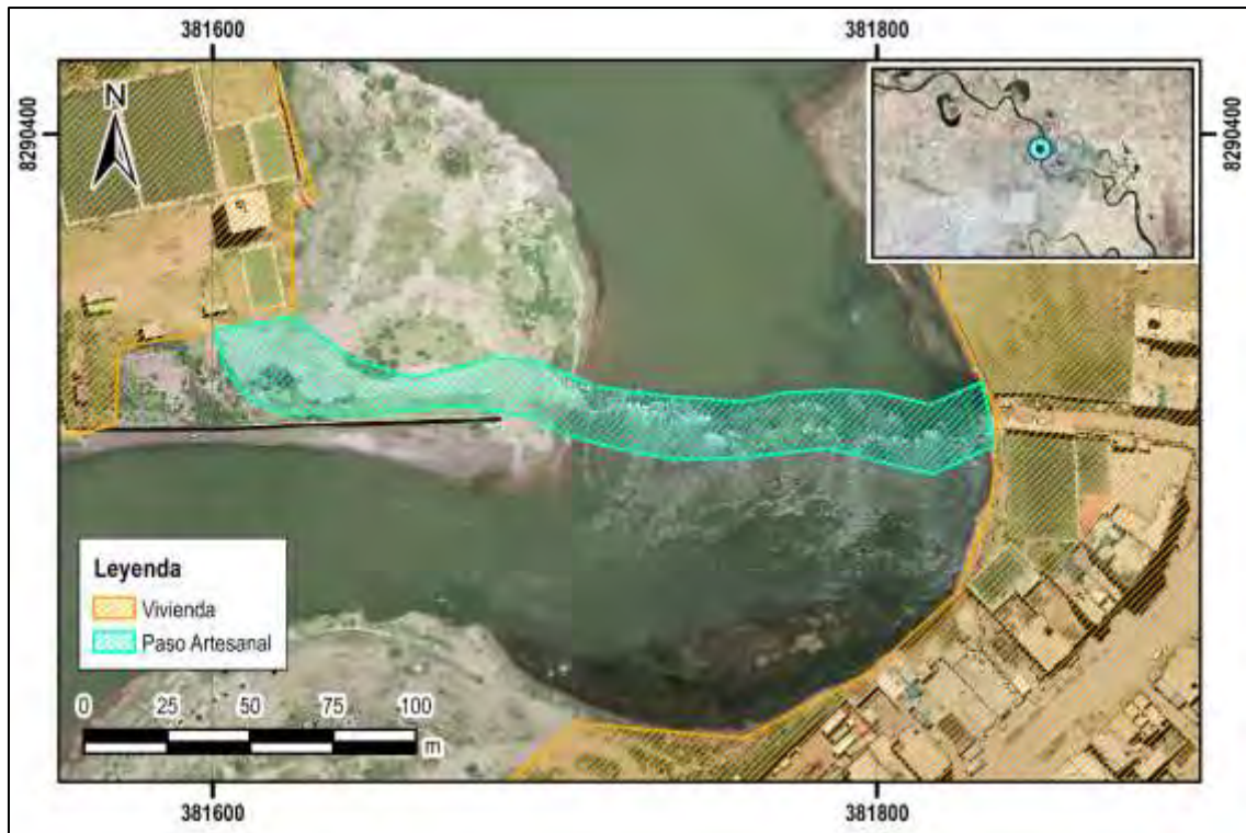
Figura F.15. Punto de reconocimiento N°15, formación antropogénica. Cruce peatonal artesanal mediante aglomerado de agregado y piedras. Fuente: Elaboración propia
