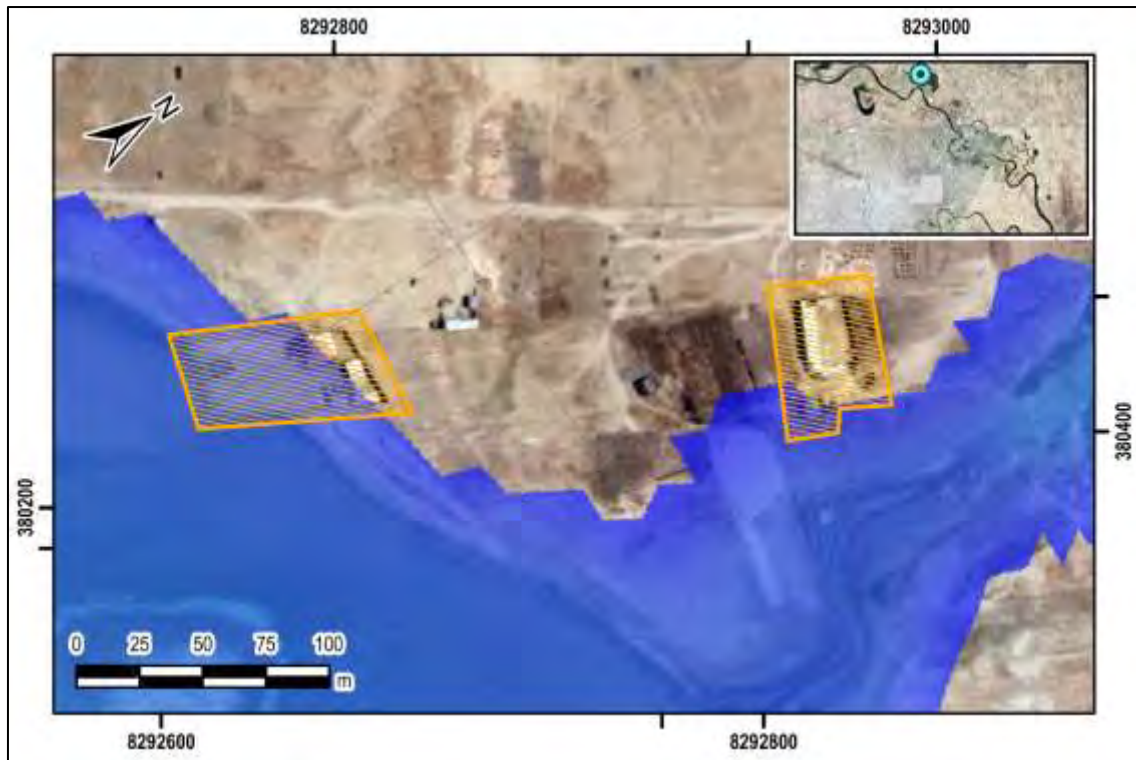
Figura F.9. Punto de reconocimiento N°9, viviendas con riesgo de inundación, ubicados en meandro abandonado del cauce del río Coata.
