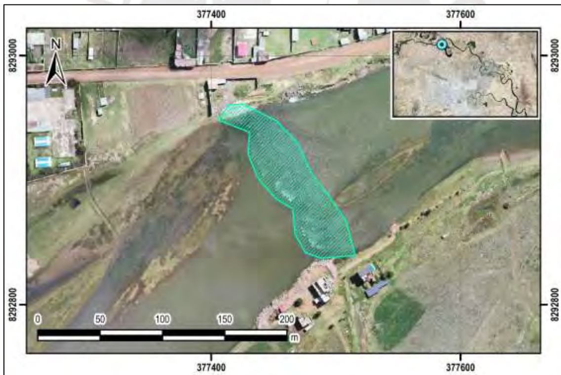
Figura F.4. Punto de reconocimiento N°4, acumulación de agregados y piedras, asimilar función de un disipador de energía. Fuente: Elaboración propia
