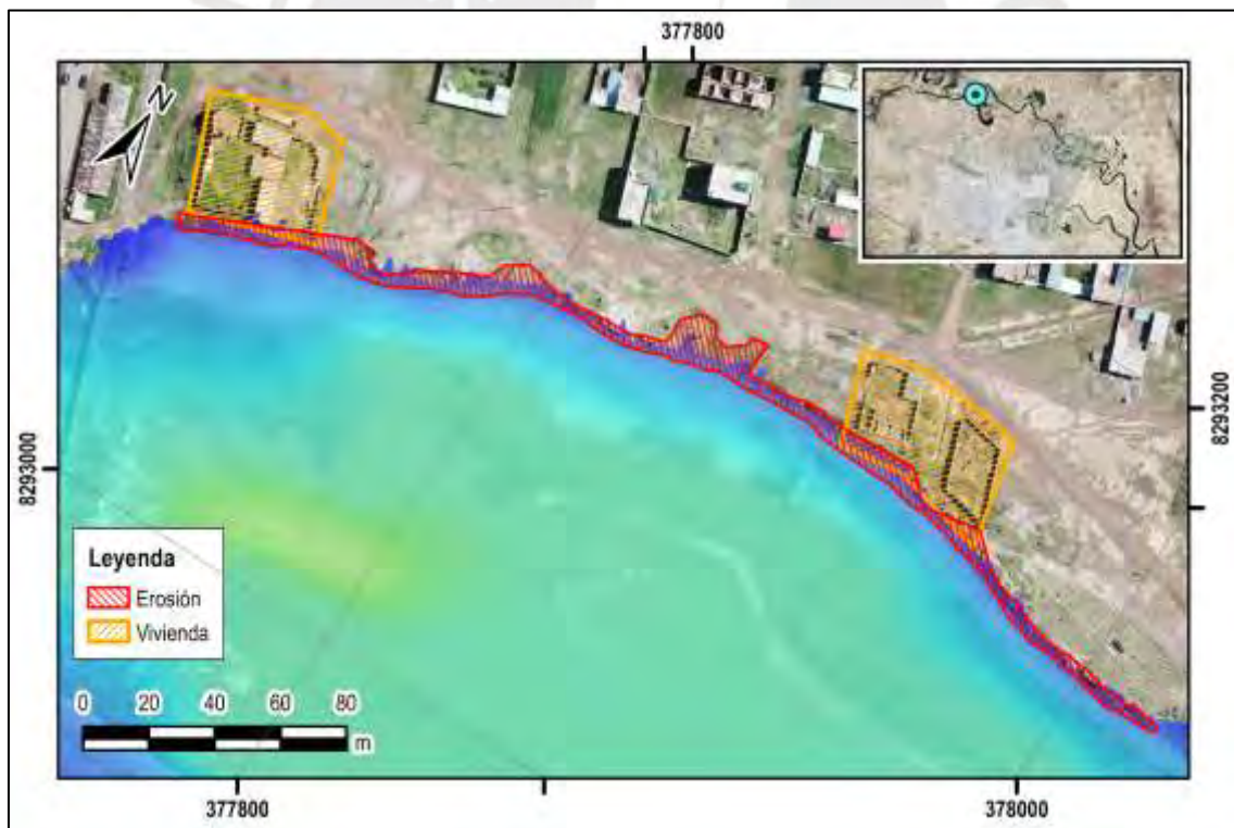
Figura F.6. Punto de reconocimiento N°6, viviendas con riesgo de falla por erosión en talud. Fuente: Elaboración propia
