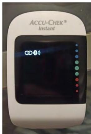
Figura 4.4: Glucómetro con símbolo de conexión inalámbrica y Bluetooth parpadeando.
