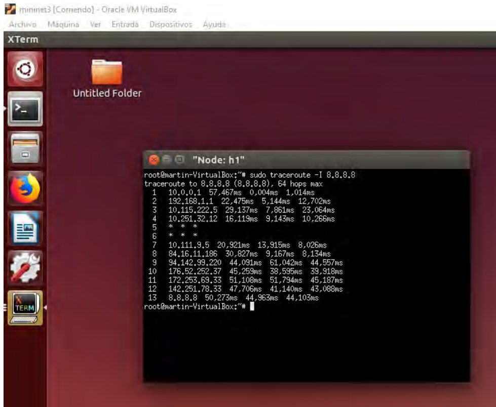
Figura 48: Ejecución del traceoute del Host1 hacia DNS de Google [Elaboración Propia].
