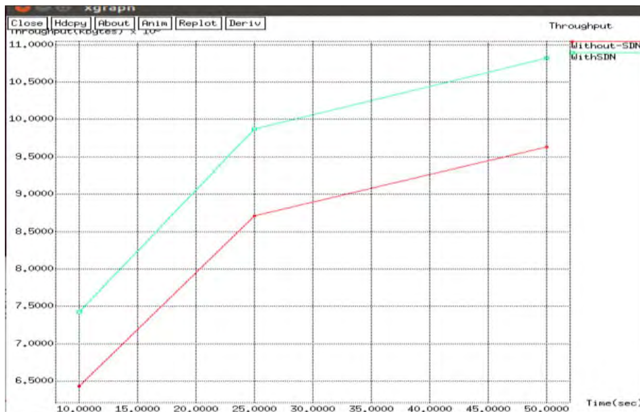
Figura 1 - 7 Comparación del throughput entre una red SDN y una convencional
