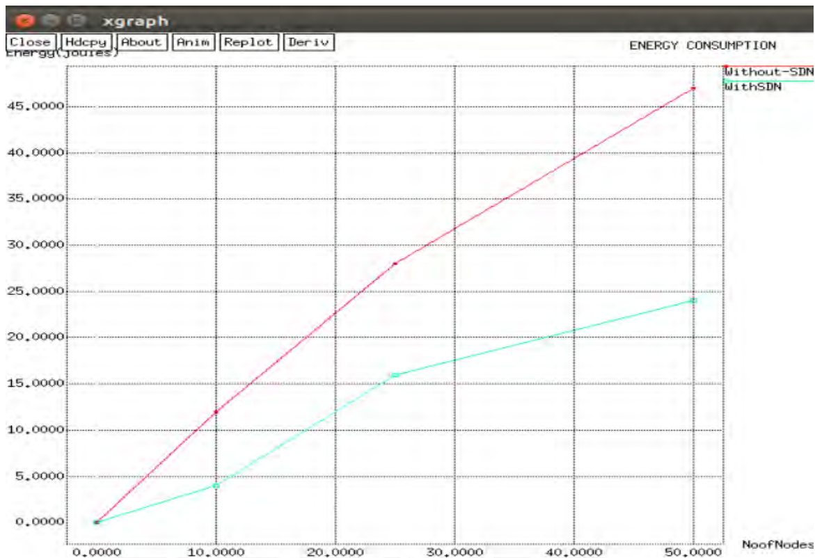
Figura 1 - 4 Comparación de consumo de energía entre una red SDN y una convencional
