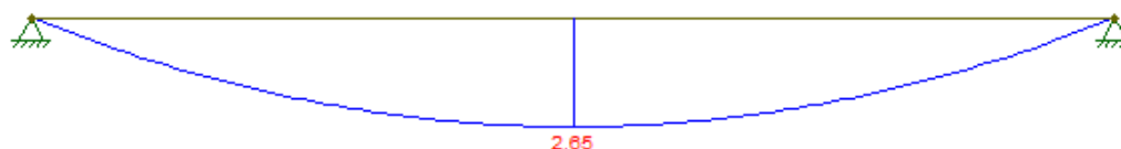
Figura N°42 : Diagrama de momento flector
