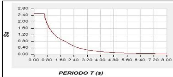
espectro de diseño representado en la Figura 6.
