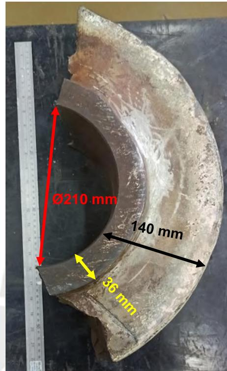
**Figura 49:** Dimensionamiento del lateral interno de la oreja A
