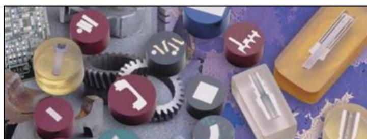
Figura 23: Muestras encapsuladas en resina [28]
