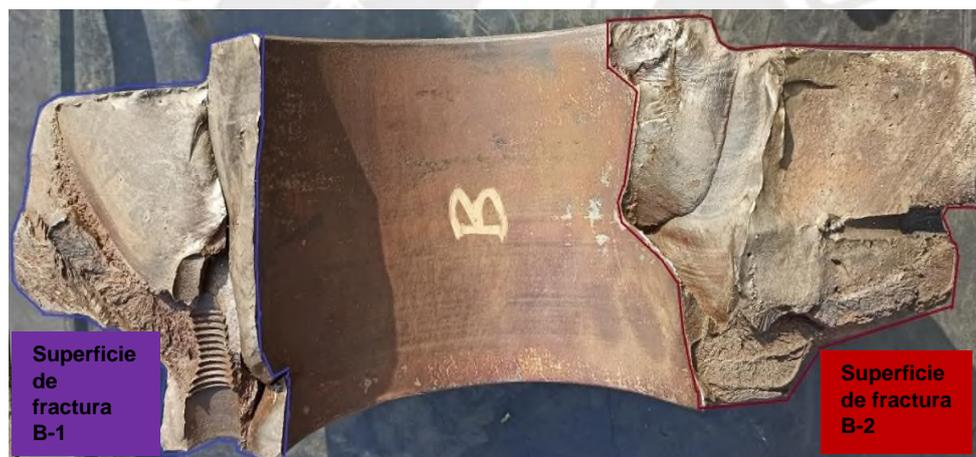
Figura 55: Identificación de superficies de fractura de la oreja fracturada B
