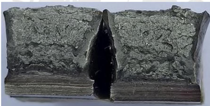
**Figura 109:** Superficies de fractura – Probeta #2 de ensayo Charpy
