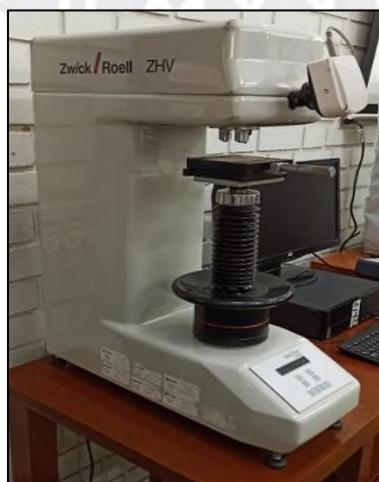
**Figura 39:** Durómetro Zwick Roell ZHV30
