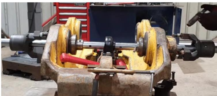
**Figura 10:** *Setup* de barra para barrenado de alojamientos de bocinas [10]
