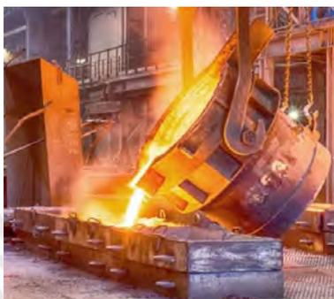
**Figura 12:** Proceso de fundición con un molde de arena [12]
