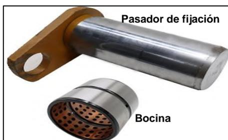
**Figura 5:** Pasador de fijación y bocina pertenecientes a componente de excavadora [6]
