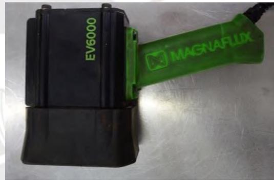
Figura 30: Lámpara de luz ultravioleta EV6000
