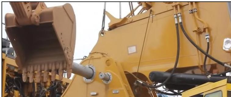
**Figura 8:** Inserción de pasador de fijación en la instalación de una excavadora [8]
