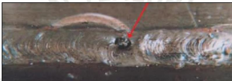
**Figura 14:** Inclusiones de escoria en un cordón de soldadura [15]
