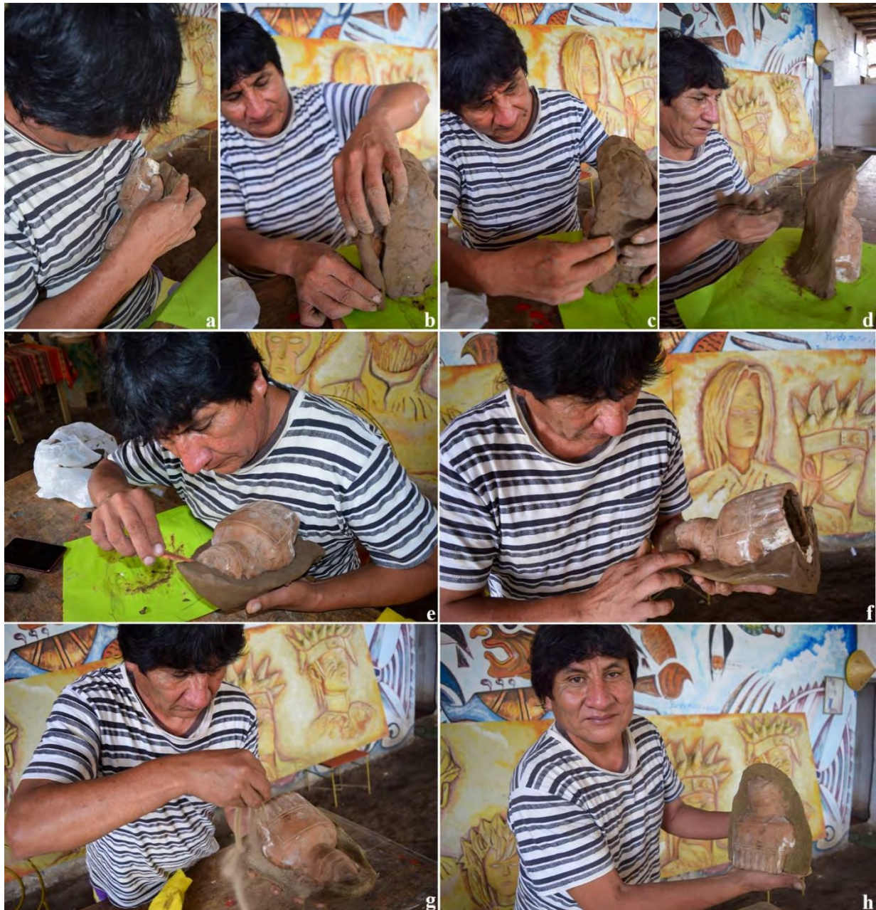
Figura 4.4. Etapa de conformado. (a-c) Aplicación de una tira de arcilla a lo largo del borde; (d) alisado de la superficie externa; (e) remoción de las impurezas presentes en el labio; (f) alisado de la superficie del labio; (g) aplicación de un estrato de arena como aislante; (h) la valva frontal quedó terminada. Fotografías por F. Mosna.
