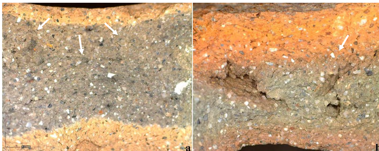
Figura 3.26. (a-b) Evidencias del uso de la técnica de enrollado en la manufactura de algunos moldes.
