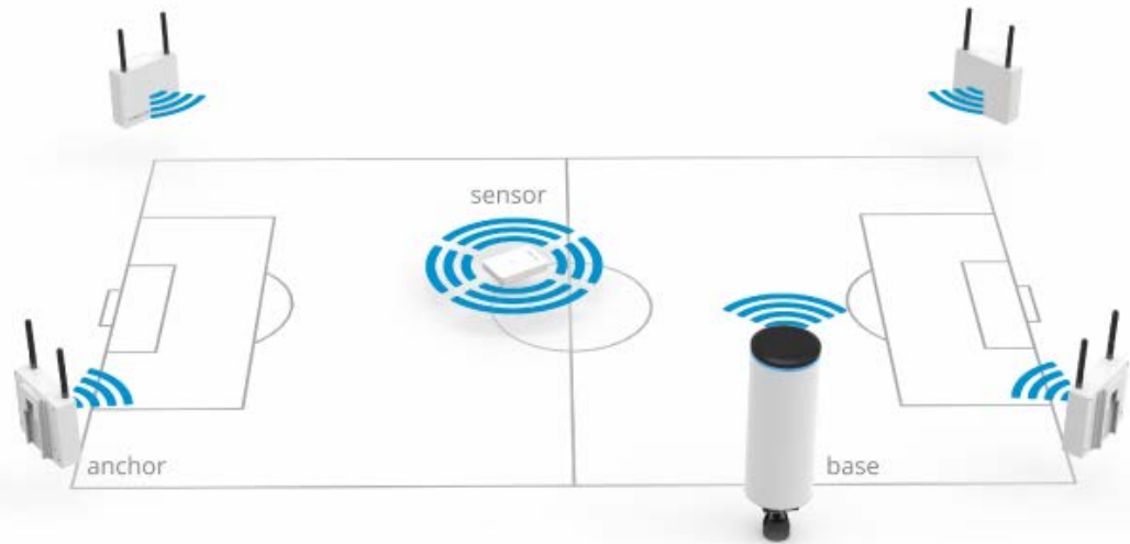
Figura 3-5: Representación de un sistema basado en UWB. Fuente: KINEXON, 2017.
