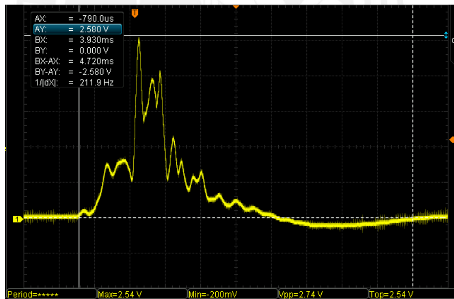
Figura 5-6: Simulación de un paso para el ADC del microcontrolador. Fuente: Elaboración propia.
