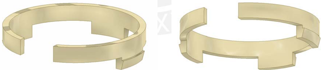
Figura 5-46: Soporte de recolector de un disco, vista superior e inferior. Fuente: Elaboración propia.
