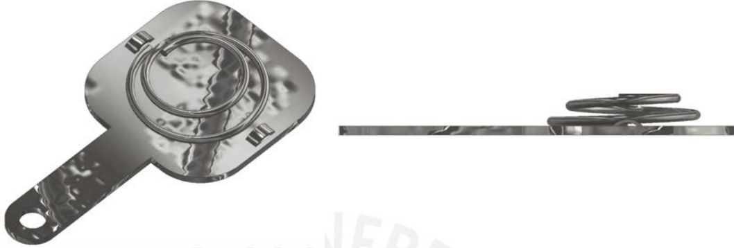
Figura 5-55: Resorte de contacto variable, vista ortogonal superior y lateral. Fuente: Elaboración propia.
