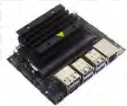
Figura 5.9: Computador Jetson Nano (Fuente: www.nvidia.com ).
