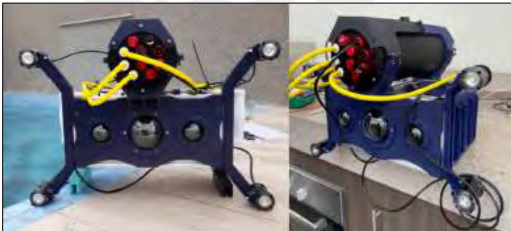
Figura 7.3: Prototipo del sistema de adquisición de imágenes submarinas (Fuente: Elaboración propia).
