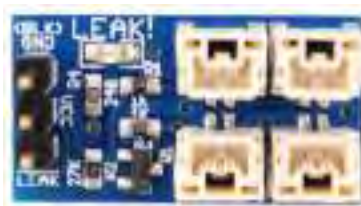
Figura 5.7: Sensor de fuga (Fuente: www.bluerobotics.com ).
