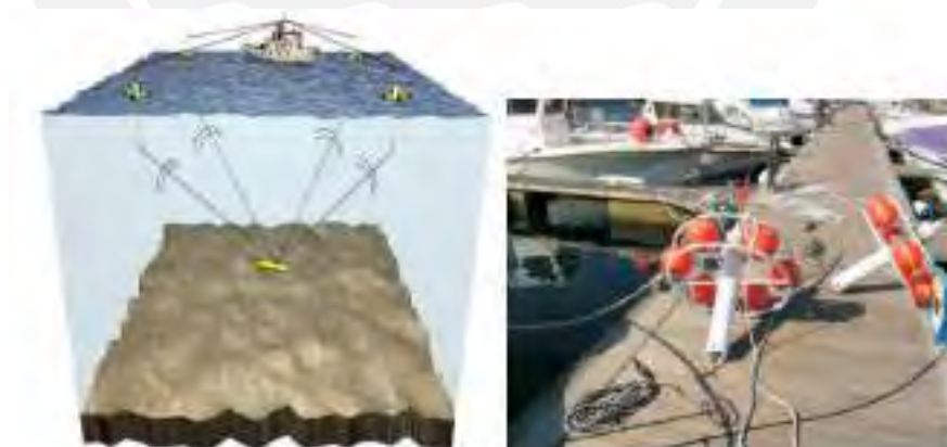
Figura A.10: Sistema GIB (izquierda) y boyas utilizadas antes de su despliegue (derecha) (Fuente: Alcocer et al.).
