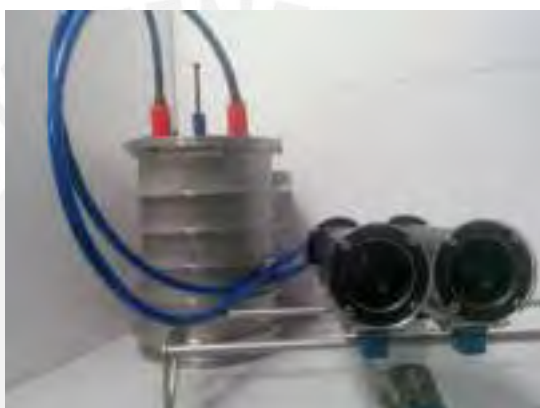
Figura A.19: Contenedor del sistema de control (izquierda) y Contenedores de las cámaras (derecha) (Fuente: Oleari et al.).
