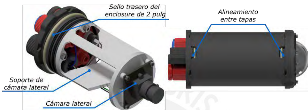
Figura 4.26: Sujetador de cámaras laterales (derecha) y alineamiento de enclosure de 2 pulg (izquierda) (Fuente: Elaboración propia).
