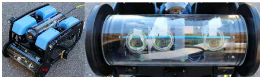
Figura 2.8: Sistema trifocal acoplado al BlueROV2 (Fuente: Nawaf et al.).
