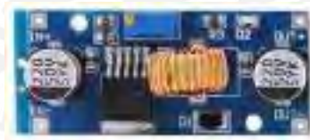
Figura 5.12: Regulador de voltaje XL4015
