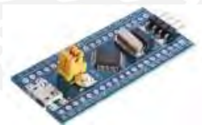
Figura 5.10: Microcontrolador Blue Pill (Fuente: www.mercadolibre.com.pe ).
