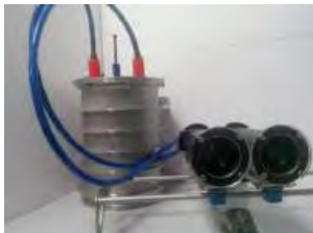
Figura 2.5: Contenedor del sistema de control (izquierda) y Contenedores de las cámaras (derecha) (Fuente: Oleari et al.).
