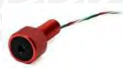
Figura 5.2: Sensor Bar30 (Fuente: www.bluerobotics.com ).
