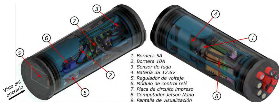
Figura 5.24: Componentes en el enclosure principal - Buzo (Fuente: Elaboración propia).
