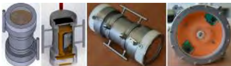
Figura 2.9: Sistema de estereovisión portátil (Fuente: Nawaf et al.).
