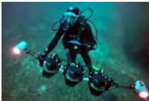
Figura 1.3: Sistema para fotogrametría compuesto por tres cámaras sincronizadas (Fuente: Drap et al.).
