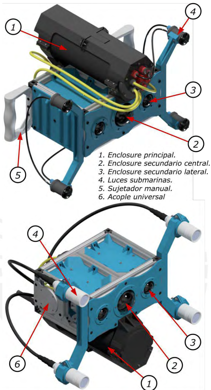
Figura 7.1: Modelo 3D del sistema para modo de uso por buzo (superior) y para uso por ROV (inferior) (Fuente: Elaboración propia).
