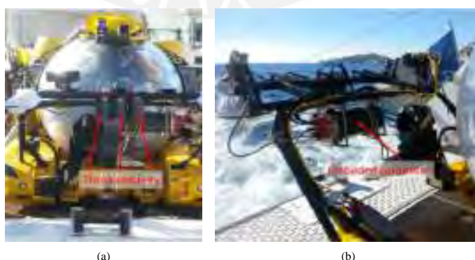
Figura A.22: Imágenes del sistema conectado al Rémora 2000 ROV (a) lista de las tres cámaras sincronizadas, (b) vista del subsistema de control encapsulado (Fuente: Drap, Merad, et al.).
