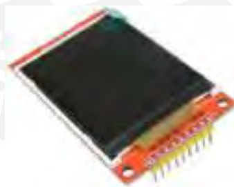
Figura 5.11: Pantalla de 2.2 pulg ILI9341
