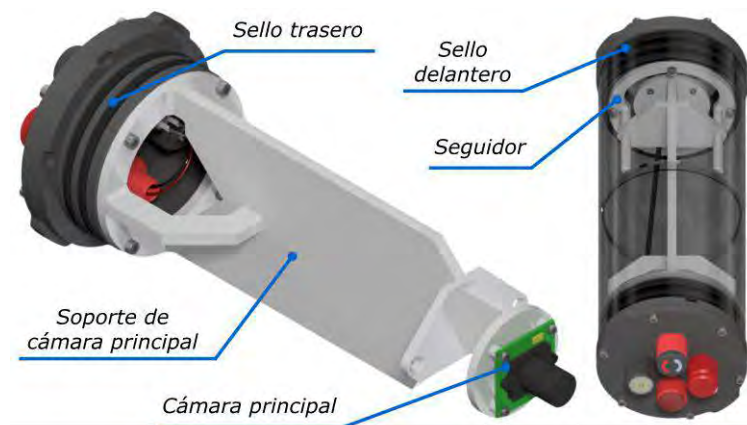
Figura 4.27: Soporte de cámara principal y elementos de alineación entre sellos laterales (Fuente: Elaboración propia).
