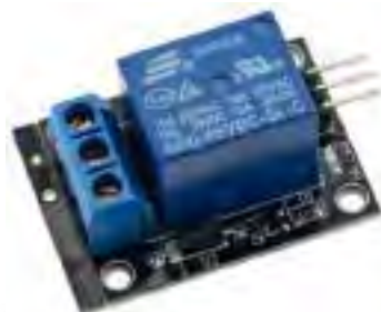
Figura 5.14: Módulo relé 5V a 1 canal (Fuente: www.mastertronicventas.com ).
