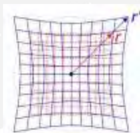
Figura A.3: Distorsión radial generada por el puerto plano
