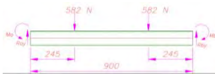
Figura 2.26 Diagrama de cuerpo libre de elemento 4 de la estructura de soporte del evaporador.
