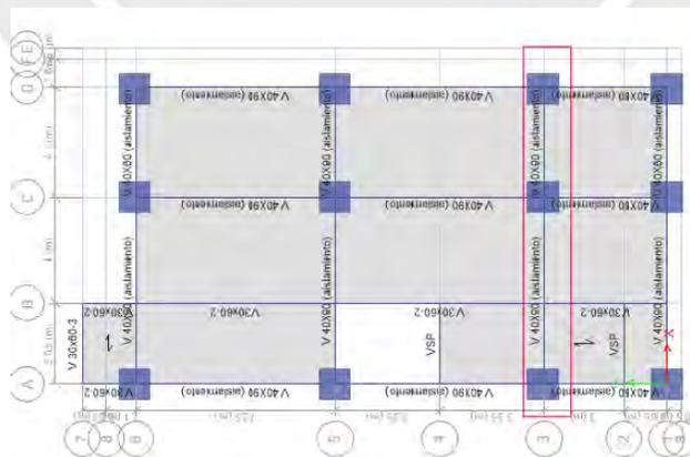
Imagen 4.36: Ubicación de la viga de aislamiento a diseñar
