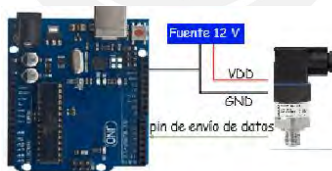
Figura 4.11. Diagrama de bloques para transmisor de presión.
