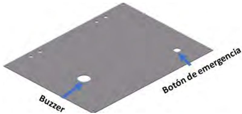
Figura 4.4. Vista isométrica de la tapa de la estructura
