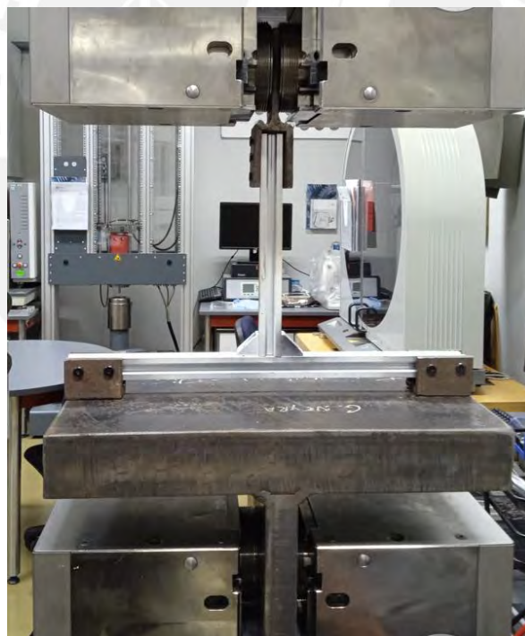
Figura 4.13: Ensamble de la probeta con la máquina de tracción Z050. Fuente: Propia
