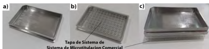
Figura 2.9: Base de acero para la plataforma de microtitulación fabricada en PDMS.
