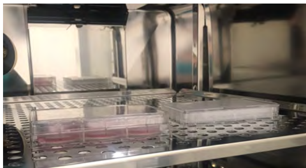
Figura 2.25: Plataforma de PDMS en la incubadora para cultivos Heracell™ VIOS 160i CO2 (Nuevo Hampshire, Estados Unidos).
