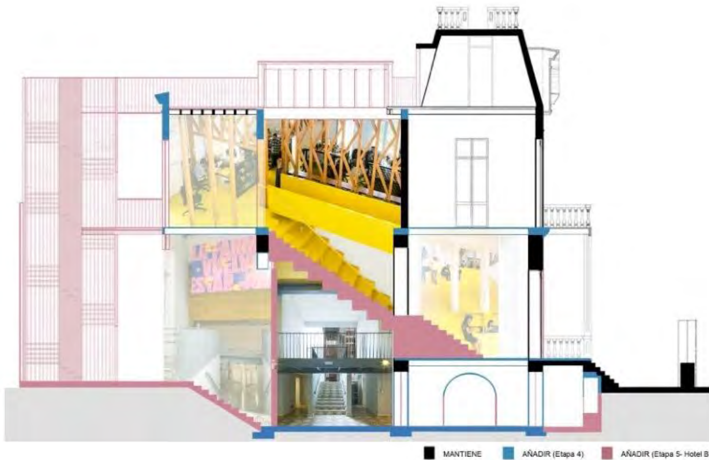
Imagen 12: Corte longitudinal Casa Apesteguía Fuente: Elaboración en base a imágenes propias y a plano Archdaily
