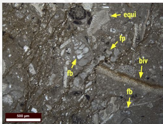
Figura 9.111: SD576769. PPL. Caliza packstone con foraminíferos bentónicos ( fb ) y planctónicos ( fp ), fragmentos de bivalvos ( biv ), ostrácodos y equinodermos ( equi ). La roca parece haber sufrido brechamiento.
