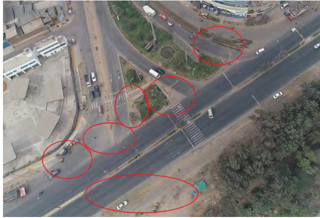
figura 76: Se puede ver en todos los puntos señalados, la falta de veredas
