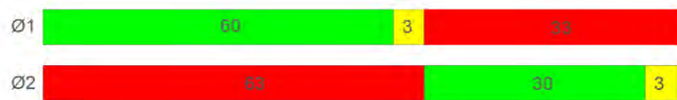
figura 43: En la imagen se puede ver el tiempo de cada fase de y los tiempos de rojo, verde, ámbar.
