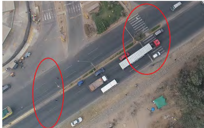
figura 73: Se observa en la imagen el lugar por donde cruzan los peatones, diferentes por el paso peatonal diseñado
