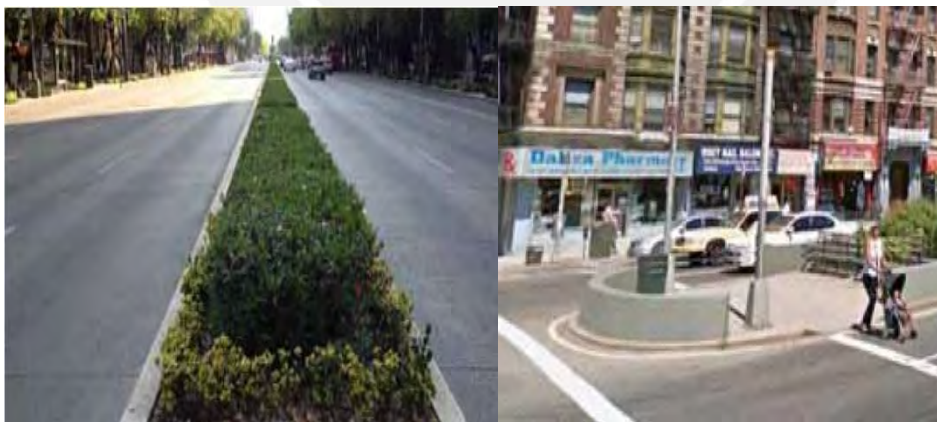
figura 3: La imagen muestra cómo se puede usar la mediana para insertar vegetación y cómo a la vez protege a los peatones
