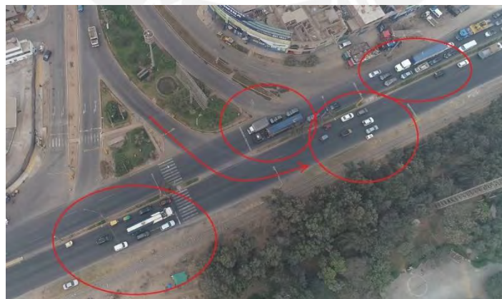
figura 77: Se ve en la imagen la posición de los semáforos y la retención que causan
