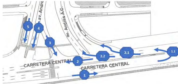
figura 35: La imagen muestra la dirección de movimiento de los vehículos con un código por movimiento
