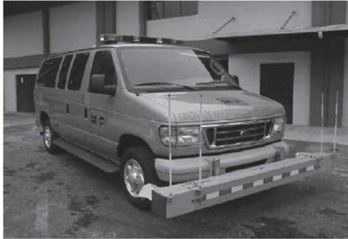
**Figura 8:** Perfilómetro inercial de precisión. Fuente: Pradena (2006b)
