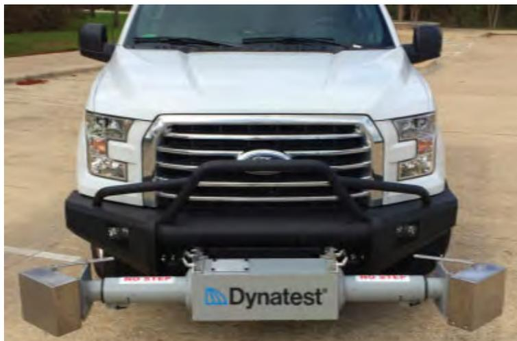
**Figura 13:** Perfilómetro Laser MK-IV. Fuente: Dynatest (2020)
