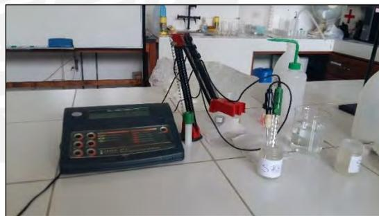
Figura N°12: Medición de pH en cada muestra
