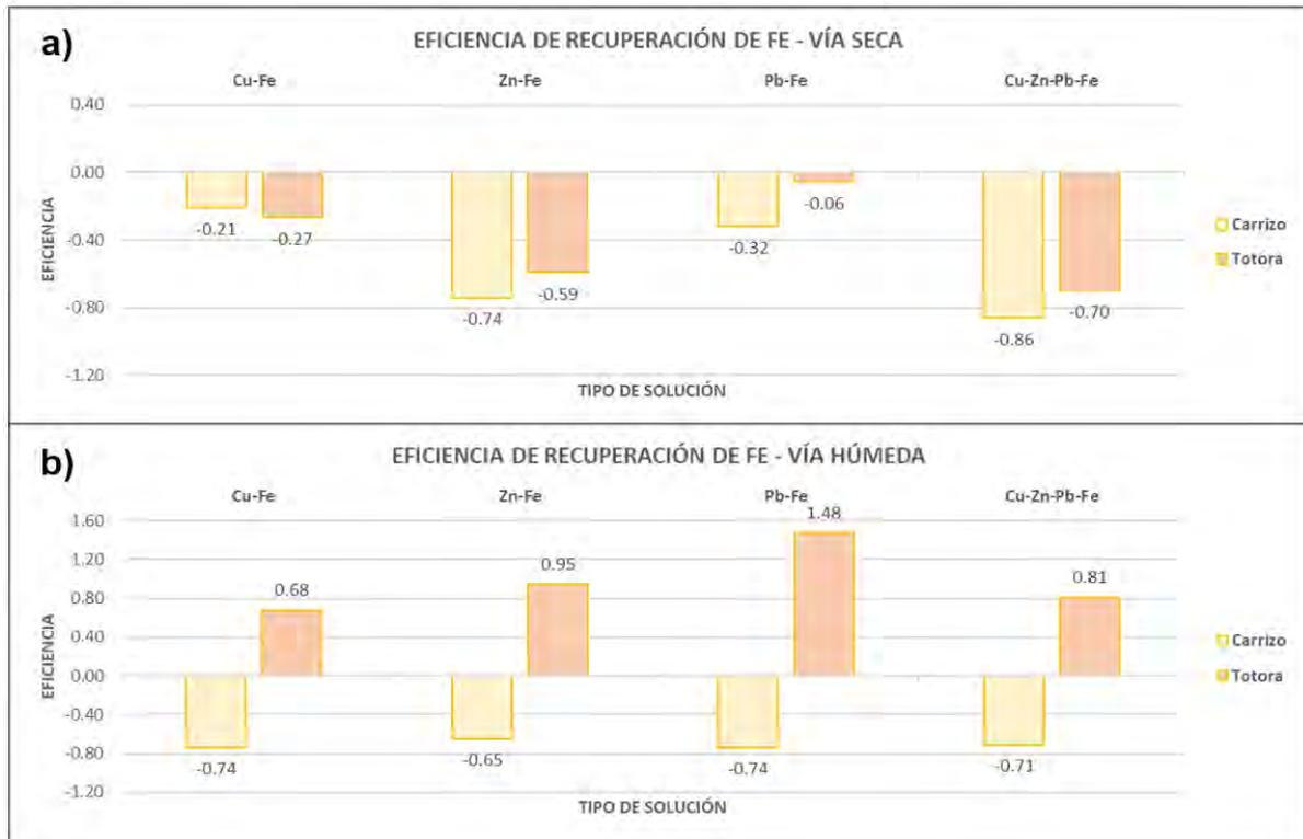
Figura N°53: Eficiencia de recuperación de Hierro: a) Vía seca y b) Vía húmeda
