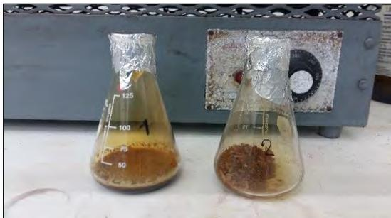
Figura N°26: Muestras en proceso de digestión
