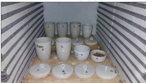
Figura N°24: Almacenamiento de muestras en los crisoles al interior de una mufla
