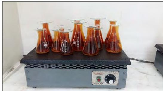
Figura N°27: Muestras sobre planchas calefactoras
