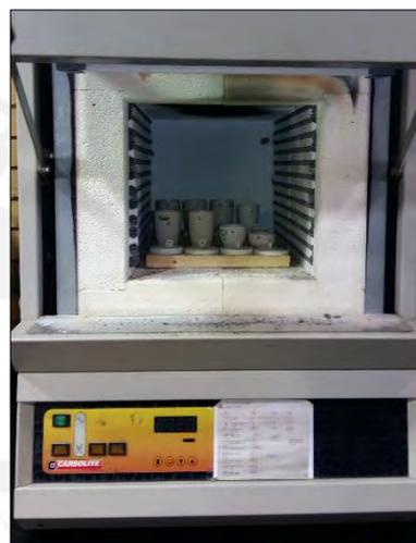
Figura N°25: Crisoles en proceso de secado dentro de hornos de mufla
