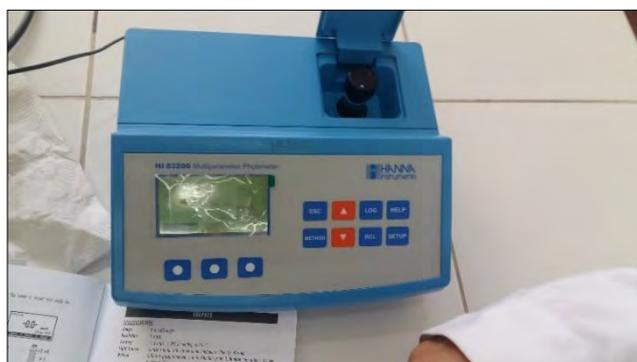
*Figura N°15:* Medición de las concentraciones de aniones indicados presente en cada muestra haciendo uso del multiparámetro
