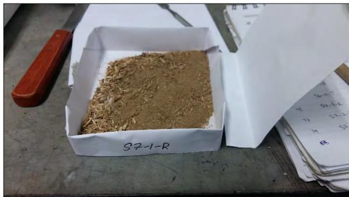
Figura N°23: Muestra final obtenida luego del secado y la trituración
