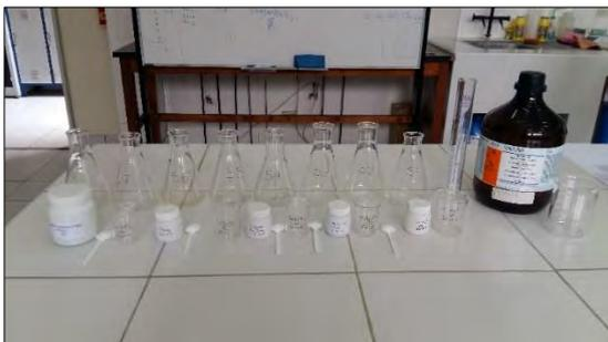
Figura N°6: Materiales empleados para la preparación de las soluciones "patrón"
