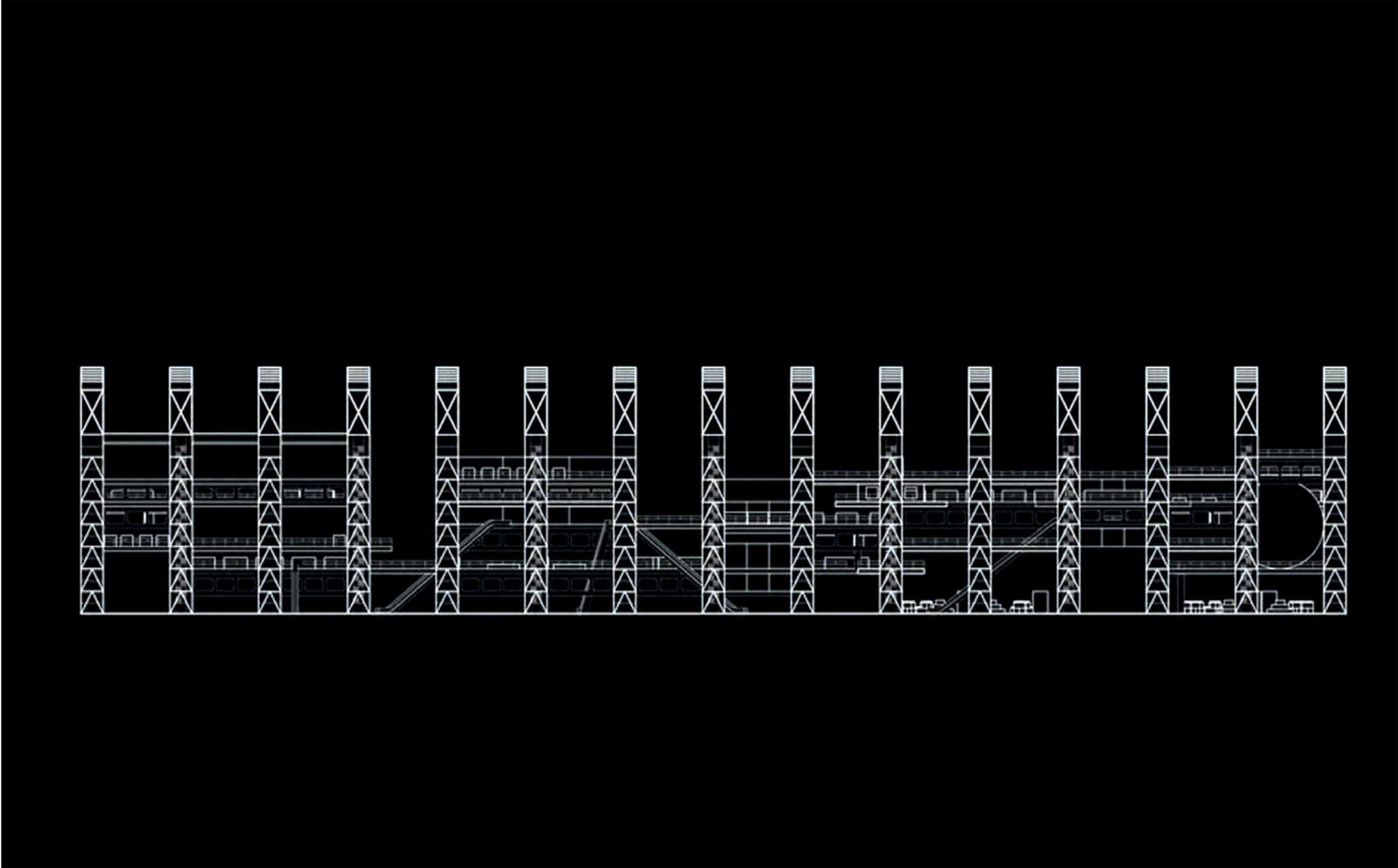
**Decodificacion:** [Estructura del fun Palace de Cedric Price de una estructura de trama y puntos especificos de apoyo , cercano a condicion tecntonica]
