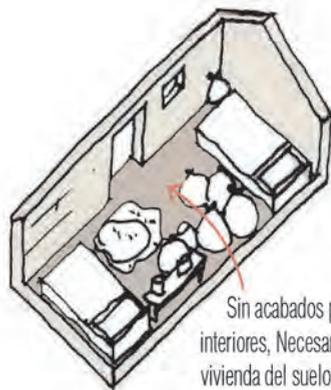
Sin acabados piso en interiores, Necesario aislar la vivienda del suelo para tener mayor confort térmico.
