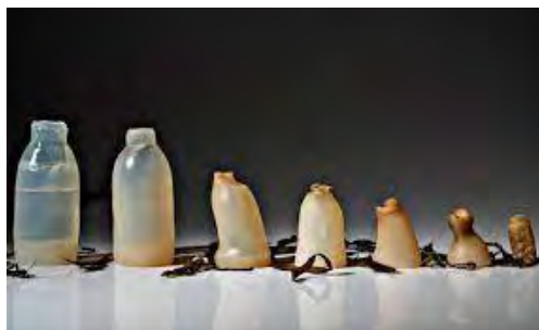
Figura 2. Proceso de descomposición de una botella fabricada con polímeros de algas marinas
