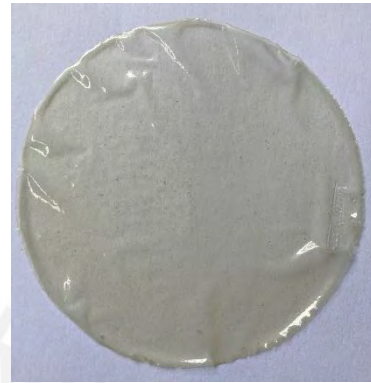
Figura 28. Film neutro con 20% glicerol
