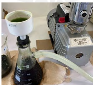
Figura 24. Filtrado de muestras en etanol con bomba de vacío
