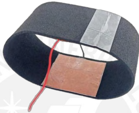
Figura 38: Imagen representativa de prototipo de TENG fabricado con lámina de biopolímero
