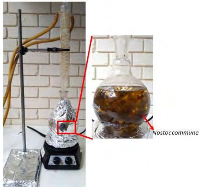
Figura 17: Sistema de reflujo armado para la extracción de EPS.
