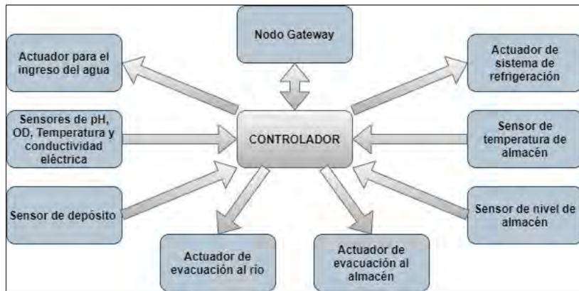
Figura E.3: Diagrama de bloques del sistema electrónico (Elaboración propia)
