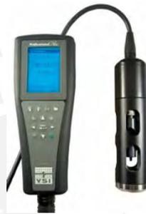
Figura 2.10: Sensor Multiparámetro (SensorVital, 2020)
