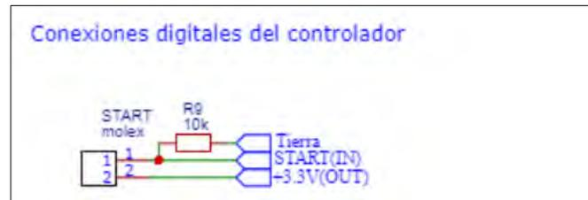
Figura 4.10: Esquemático de conexiones de digitales del controlador (Elaboración propia)
