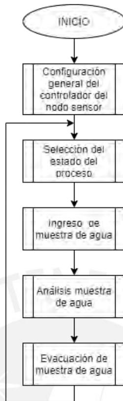
Figura 4.15: Diagrama de flujo del controlador del nodo sensor (Elaboración propia)
