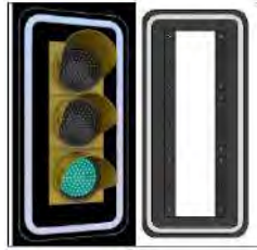
Figura 2.5: Ejemplo de placa de contraste en un semáforo Fuente: Extraído de Ministerio de Transporte y Telecomunicaciones (2016)
