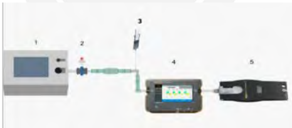
Figura 3.2: Esquema del circuito ventilador – simulador pulmonar. 1) Ventilador mecánico MASI. 2) Circuito ventilatorio incluye: Válvula PEEP de hasta 25 cmH 2 O, Filtro y corrugados. 3) Adaptador Luer Lock y jeringa de 60mL. 4) Analizador de gases. 5) Pulmón pasivo de pruebas
