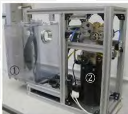
Figura 2.6: Distribución mecánica del módulo I-Lung. (1) Cámara torácica. (2) El sistema de cilindro con pistón. (3) Motor DC con sus engranajes [FORJAN,2012]
