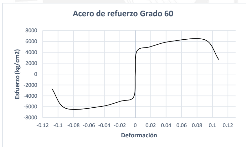
Figura 4.2. Curva de esfuerzo-deformación del acero de refuerzo grado 60 Fuente: Propia
