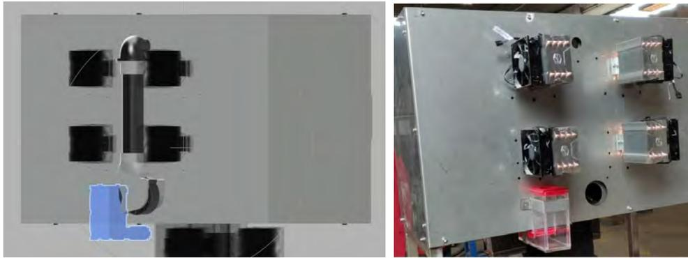
Figura 2.10: Ubicación del Sistema humidificador por Ultrasonido, vista posterior de la cámara de las muestras. La humedad se distribuye en la cámara utilizando un ventilador que mueve el aire de la parte inferior hacia la parte superior.
