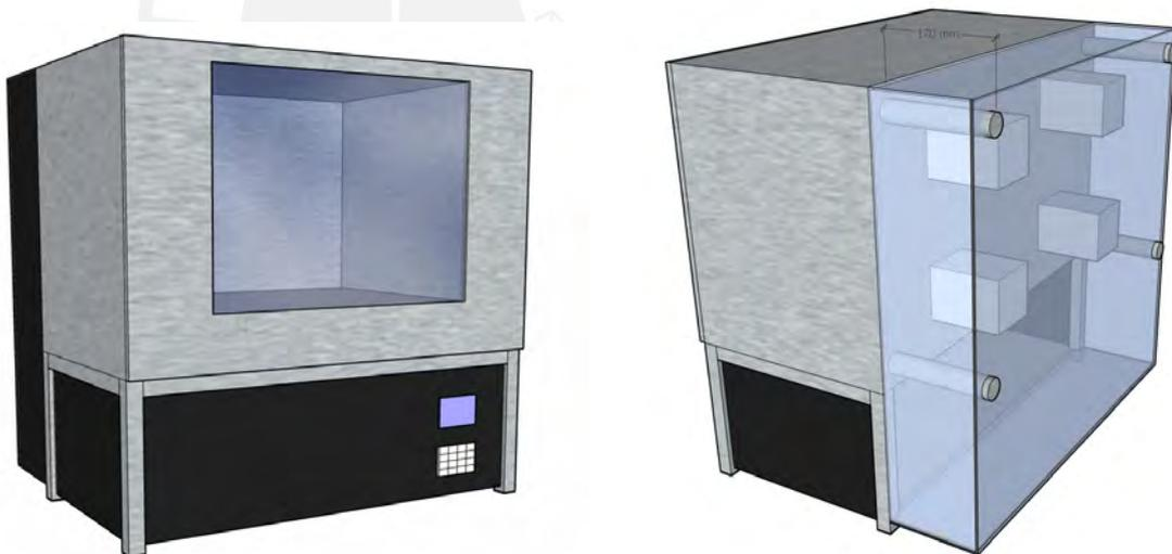
Figura 2.1: Diseño de la cámara de envejecimiento, vista delantera y trasera.
