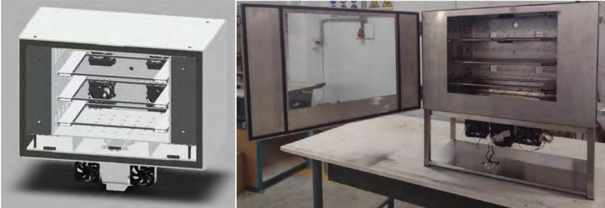
Figura 2.2: Diseño e implementación vista frontal de la cámara de envejecimiento.
