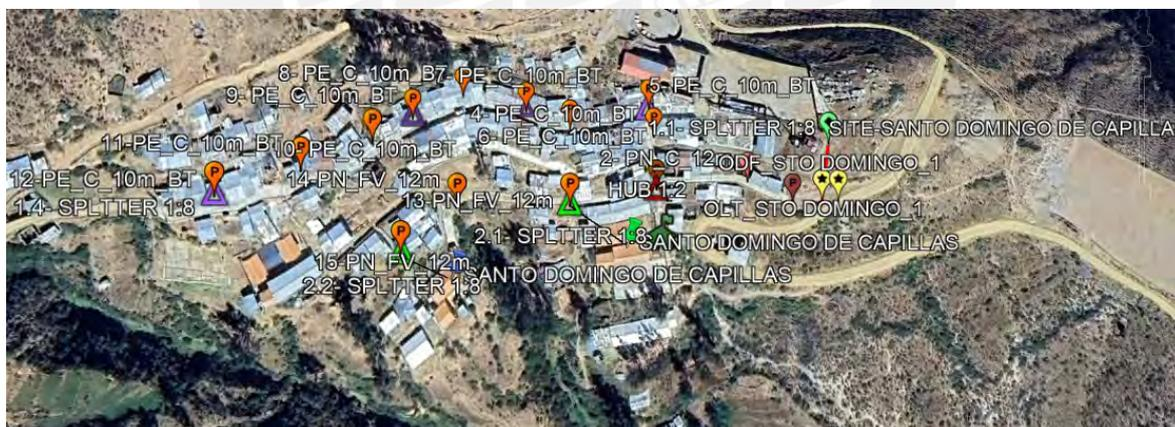
De la figura anterior, se distingue dos rutas una superior en color morado y otra inferior en color verde, ambos van a dividirse a partir del primer HUB 1:2, que tendremos después de la OLT.
