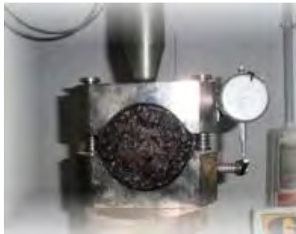
Figura 8. Mezcla de asfalto reforzado con algas sometida a ensayo Marshall. Las características físicas y mecánicas del material se ven mejoradas (Real et al., 2016).
