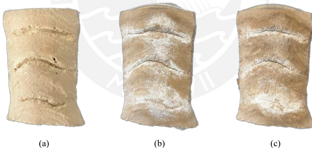
Figura 30. Proceso de auto-reparación de filamentos de matrices de suelo. (a) Inmediatamente luego de intervención en filamento. (b) Posterior a 7 días de aplicación enzimática. (c) Posterior a 14 días de aplicación enzimática.
