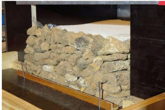
*Figura 2. 7. Espécimen a escala reducida (piedras) del muro de contención de junta seca [31]*
