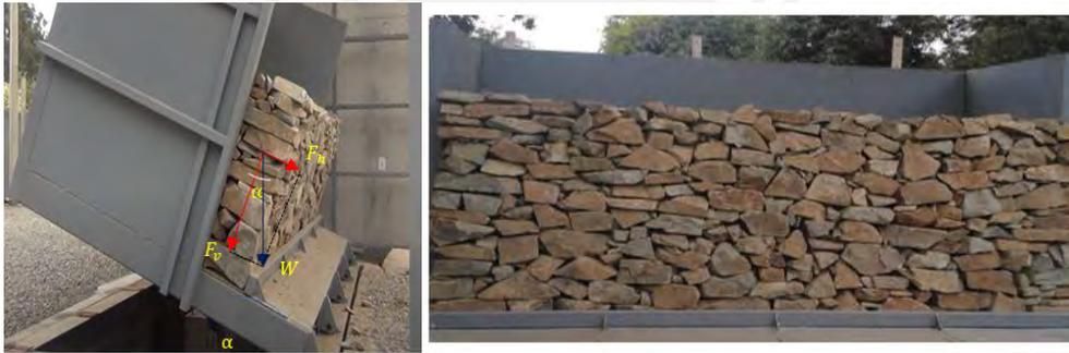
Figura 5.5 Modelo real, espécimen 5 (Adaptado de Ita et al.[5]). a) Modelamiento de cargas. b) Elevación longitudinal
