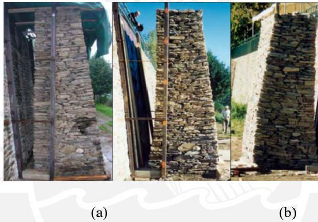
Figura 2. 2. Espécimen ensayado por Villemus et al. (2006)[7]. a) Espécimen antes del ensayo. b) Espécimen luego del ensayo
