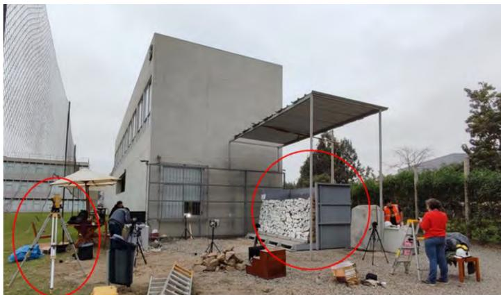
Figura 8.4. Vista del lugar de ensayo. Se muestra la mesa inclinable y la estación total
