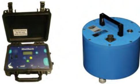
Figura 8.41. Equipos utilizados. a) MiniShark. b) Sensor sísmico
