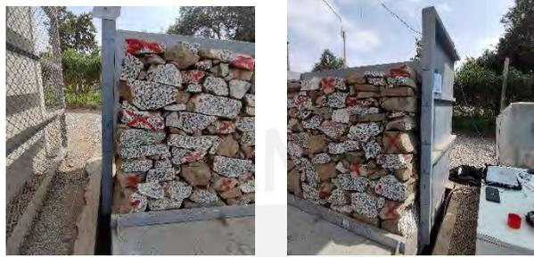
*Figura 8.8. Bordes laterales de los muros, sin restricciones*
