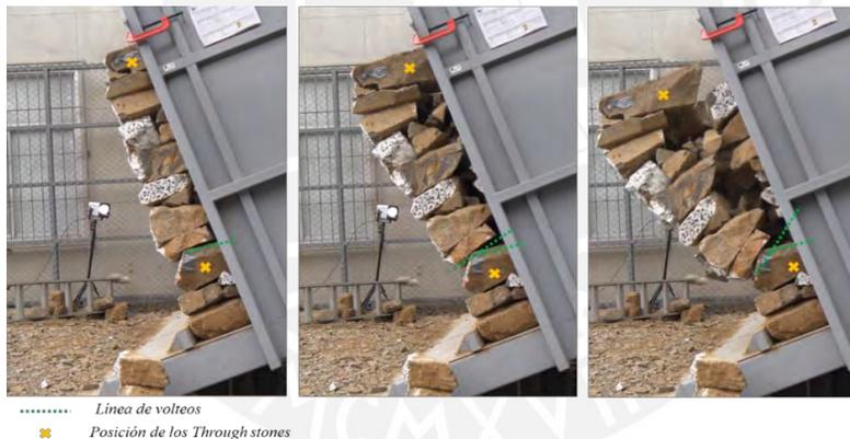
*Figura 8.20. Colapso tipo 1 (Delaminación parcial o total de la sección transversal y volteo de la sección delaminada): Secuencia de colapso del espécimen 3*
