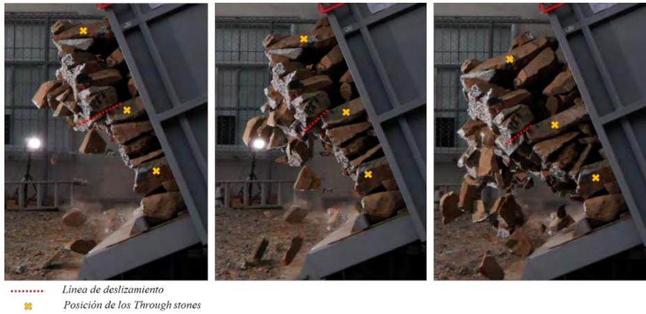
Figura 8.21. Colapso tipo 2 (Deslizamiento de una sección por delaminación parcial o total): Secuencia de colapso del espécimen 2
