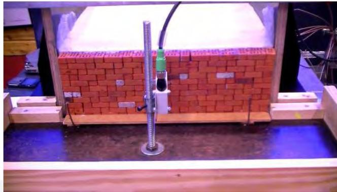
*Figura 2. 6. Espécimen a escala reducida (elementos de arcilla) del muro de contención de junta seca [11]*
