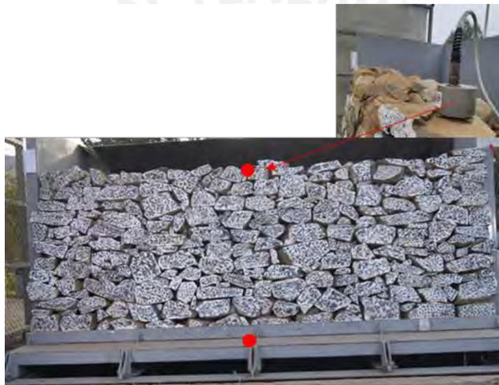
Figura 8.42. Medición de vibración ambiental en muro de configuración 2
