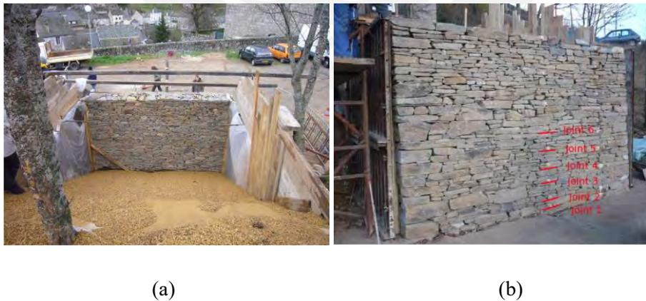
Figura 2. 3. Espécimen ensayado por Colas et al. (2008)[27]. a) vista posterior. b) vista frontal
