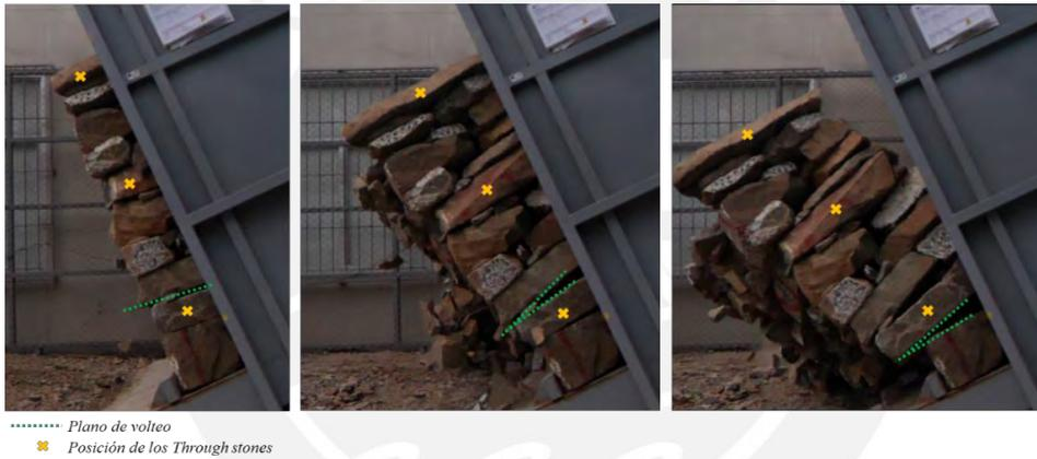
Figura 8.22. Colapso tipo 3 (Volteo de toda la sección del muro): Secuencia de colapso del espécimen 8
