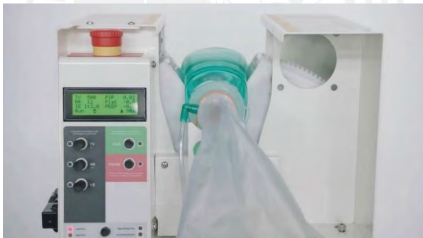
Figura 1.11. Ventilador de emergencia Spiro Wave.
