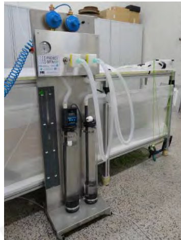
Figura 1.7. Prototipo configurado para realizar las pruebas. Tomado de “Prototype of an affordable pressure-controlled emergency mechanical ventilator for COVID-19”, por Pereira et al., 2020.
