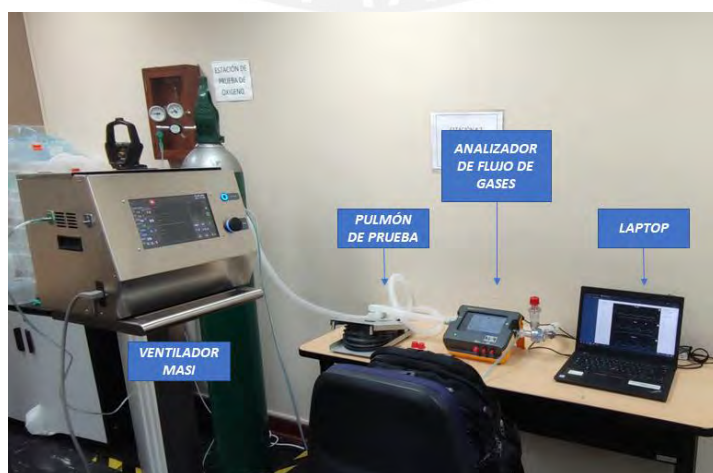
Figura 3.1. Estación para pruebas de calibración de Ventilador Masi. Nota: Fotografía propia tomada en el LabMet.
