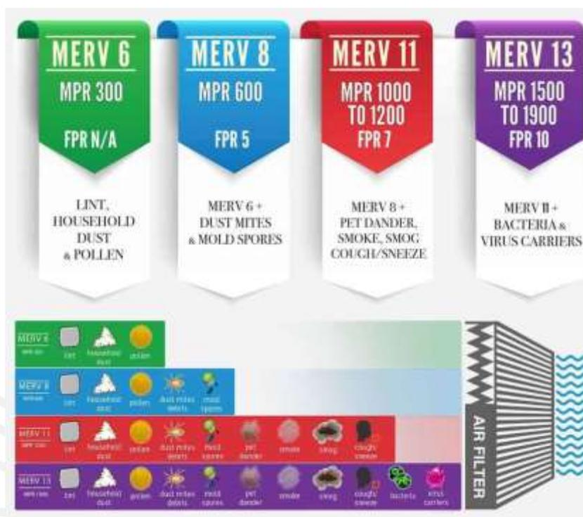
Figura 1-2 Clasificación filtros MERV (EMF SURVEY, 2021)
