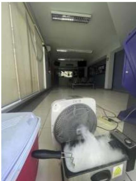
Figura 2-2 Proceso de sublimación del hielo seco en una freidora con agua, ventilador con el que se esparce, cooler para conservación del hielo seco. Pruebas realizadas en la recepción del centro de salud de la PUCP.
