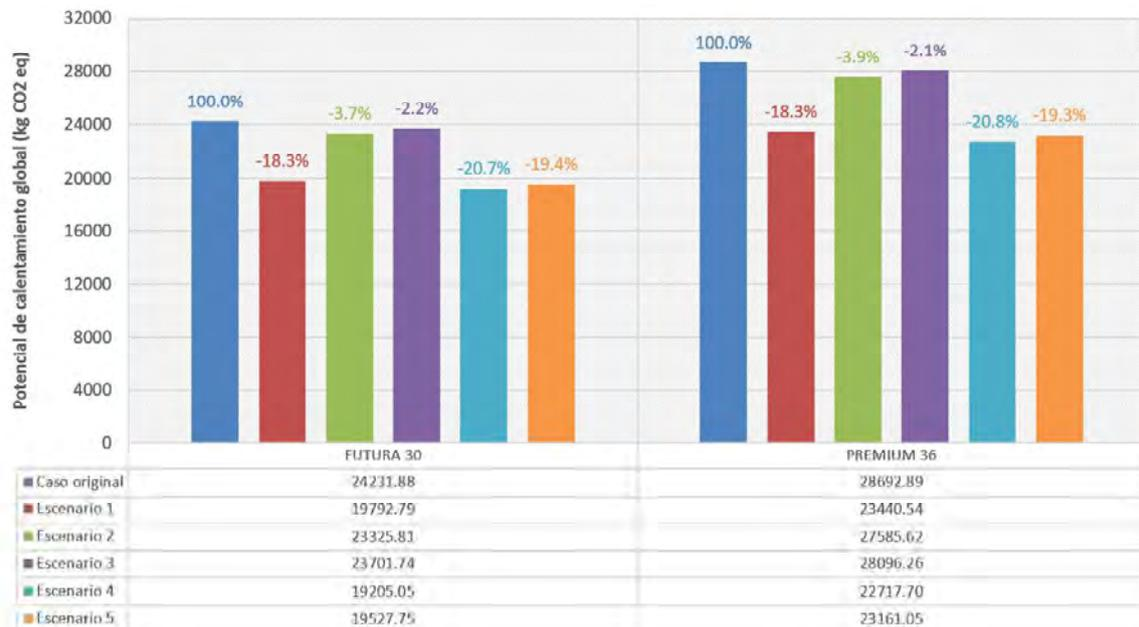
Figura 14. Comparación de escenarios del potencial de calentamiento global para módulos de placas. Cemento puzolánico (Escenario 1); Ladrillo sílico calcáreo (Escenario 2); Placas de yeso (Escenario 3); Cemento puzolánico y ladrillo sílico calcáreo (Escenario 4); Cemento puzolánico y placas de yeso (Escenario 5).
