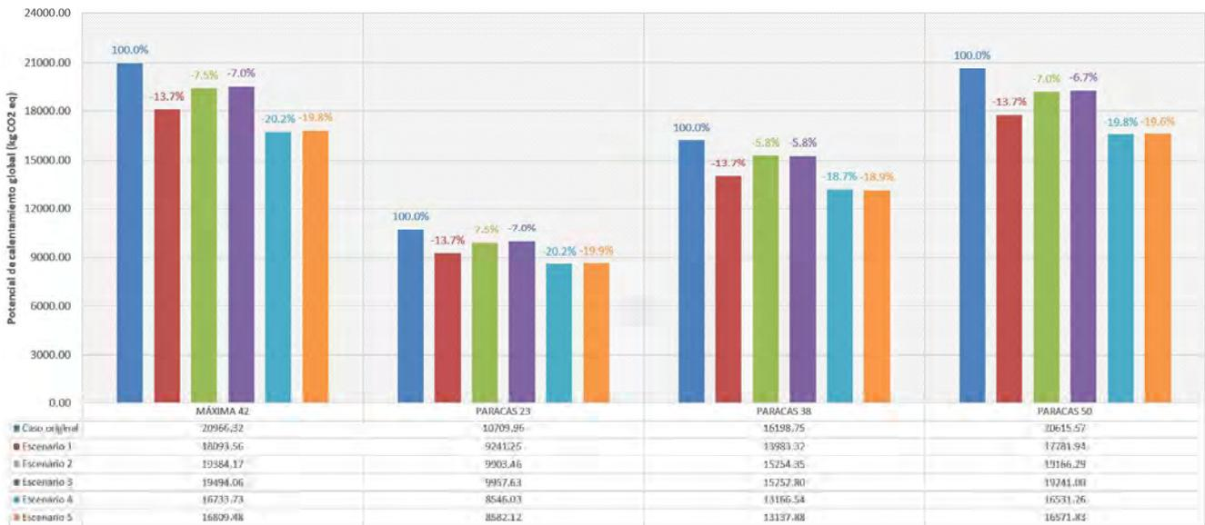
Figura 21. Comparación de escenarios del potencial de calentamiento global para módulos de albañilería. Cemento puzolánico (Escenario 1); Ladrillo sílico calcáreo (Escenario 2); Placas de yeso (Escenario 3); Cemento puzolánico y ladrillo sílico calcáreo (Escenario 4); Cemento puzolánico y placas de yeso (Escenario 5).
