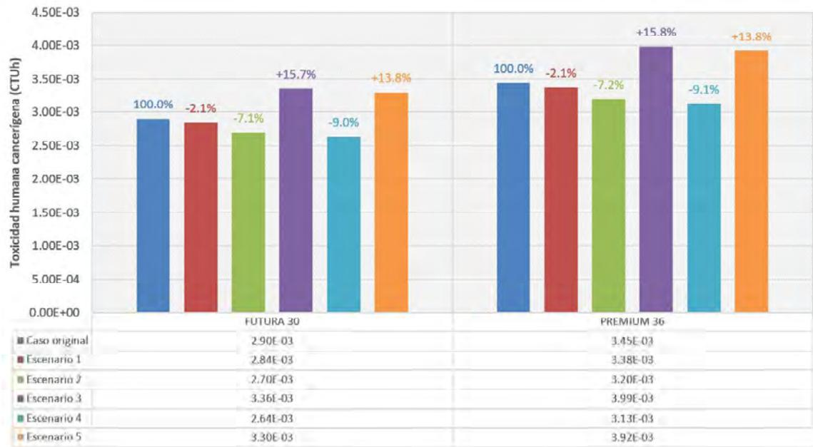
Figura 15. Comparación de escenarios de la toxicidad humana cancerígena para módulos de placas. Cemento puzolánico (Escenario 1); Ladrillo sílico calcáreo (Escenario 2); Placas de yeso (Escenario 3); Cemento puzolánico y ladrillo sílico calcáreo (Escenario 4); Cemento puzolánico y placas de yeso (Escenario 5).
