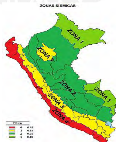
Figura 3.1. Mapa de zonificación sísmica del Perú. Recuperado de “Diseño sismorresistente”, del Ministerio de vivienda, construcción y saneamiento, 2016.
