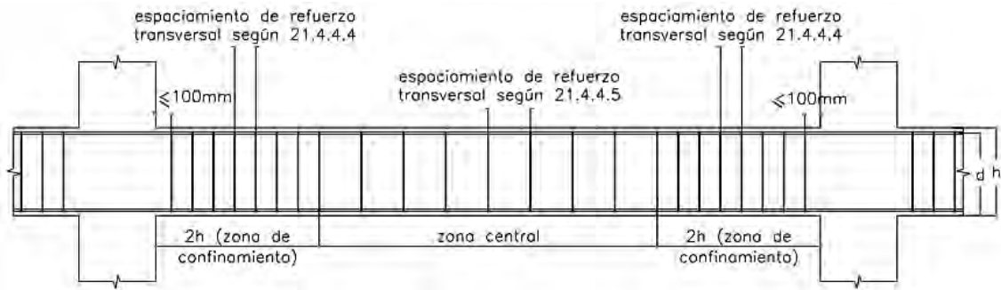
Figura 4.2. Requerimientos de estribos en vigas
