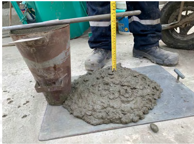
Figura 26. Medición del asentamiento (slump) del concreto Fuente: propia.
