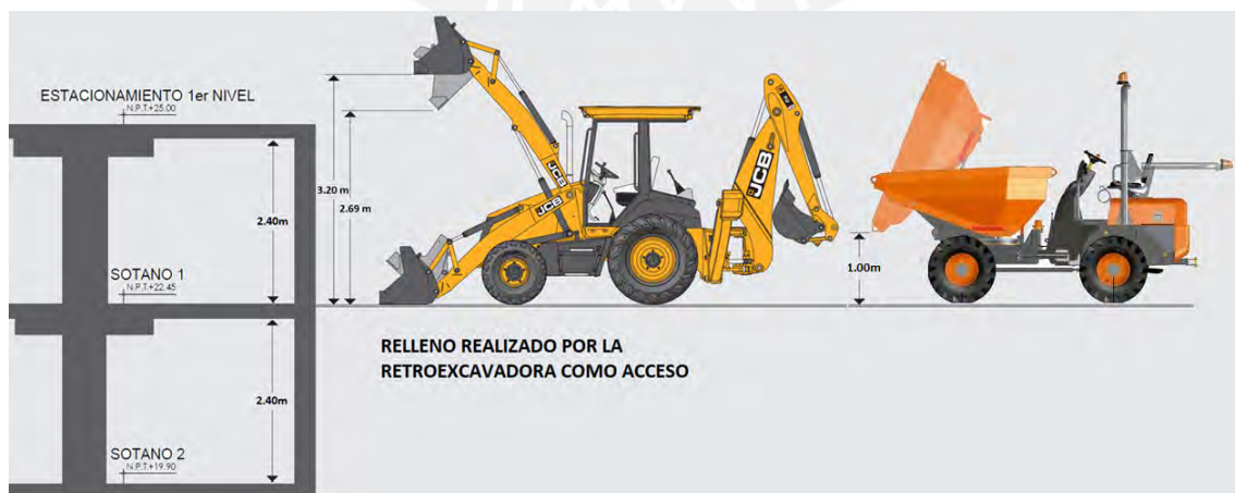
Figura 42. Elevación de vaciado con equipos para análisis Fuente: Propia.
