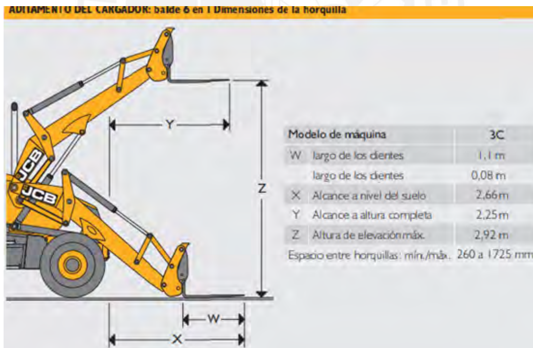
Figura 21. Dimensiones de la horquilla de la retroexcavadora JCB 3C Fuente: www.jcb.com
