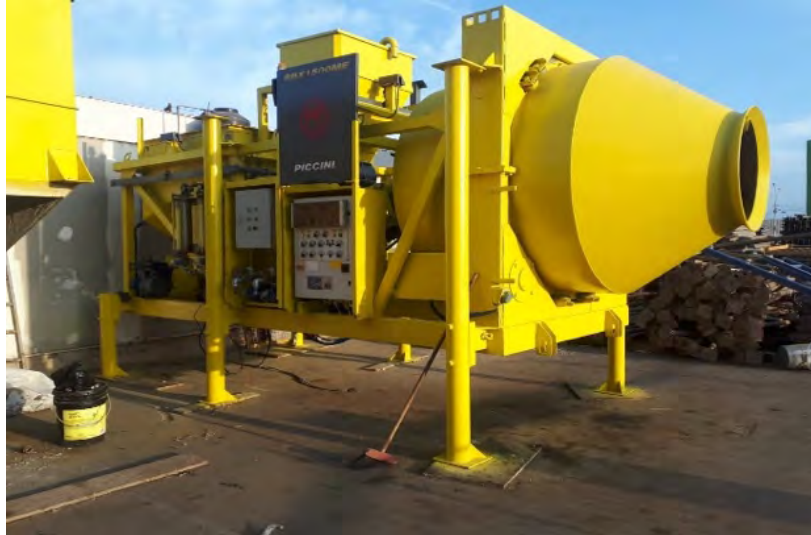
Figura 13. Planta de concreto Piccini RBX 1500 Fuente: propia.
