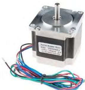
Figura 2.18 Motor de Paso<sup>7</sup>.
