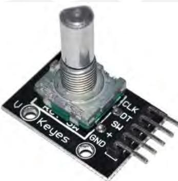
Figura 2.20 Módulo de encoder<sup>9</sup>.
