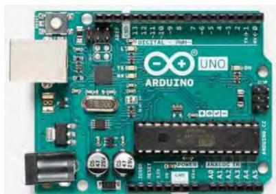
Figura 2.25 Unidad de microcontrolador Arduino UNO<sup>14</sup>.
