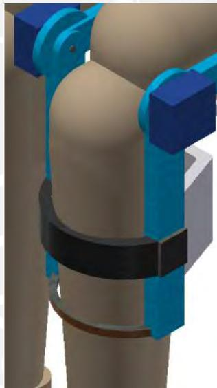
Figura 4.8 Dispositivo ajustado a la pierna
