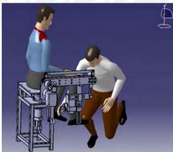
Figura 2.10 Robot de rehabilitación de rodilla [Akdoğan, 2009]
