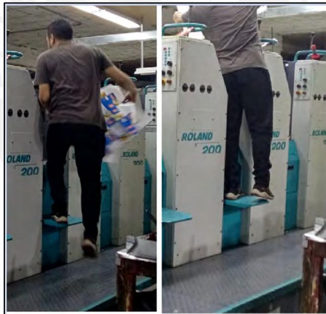
Figura 112. Postura de trabajo – impresión (inspección de nivel tinta y su cambio)
