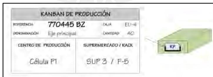
Figura 29. Tarjeta Kanban de producción
