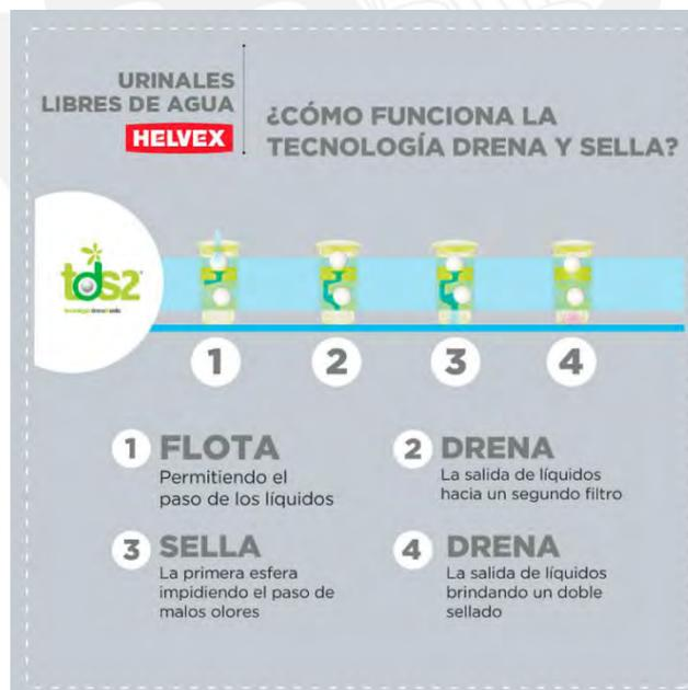
Figura 40. Funcionamiento del sistema TDS2
