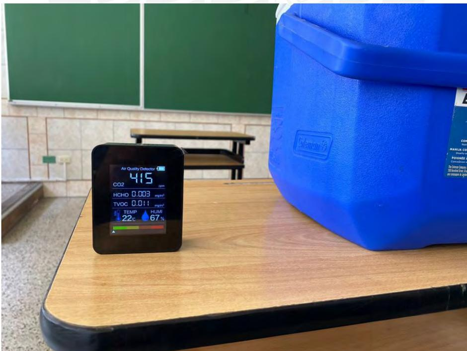
Figura 47. Colocación del medidor de CO<sub>2</sub> en el centro del salón a una altura aproximada de 1 metro.
