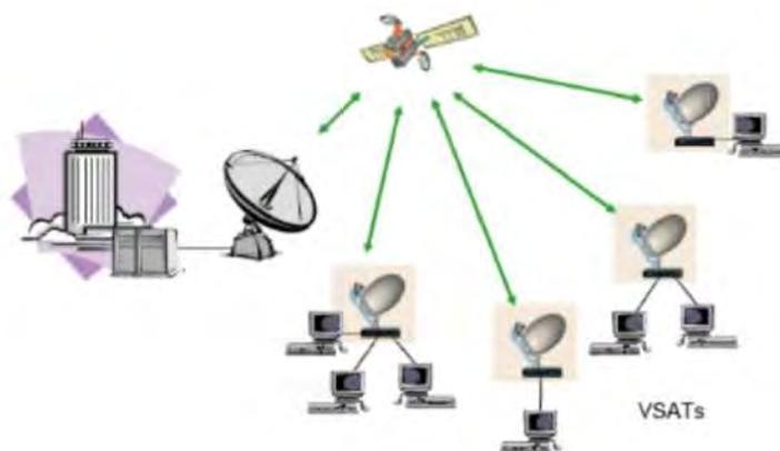
Figura 7. Elementos de una red VSAT
