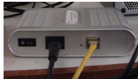
Figura 4.2. Módem PLC y sus Interfases de Red Eléctrica y Datos
