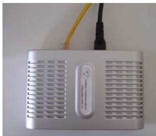
Figura 4.2. Módem PLC y sus Interfases de Red Eléctrica y Datos
