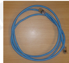
Cable de Red CAT – 5 (2)
