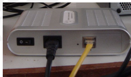
Figura 4.2. Módem PLC y sus Interfases de Red Eléctrica y Datos
