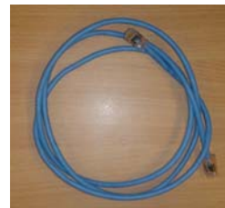
Cable de Red CAT – 5 (2)
