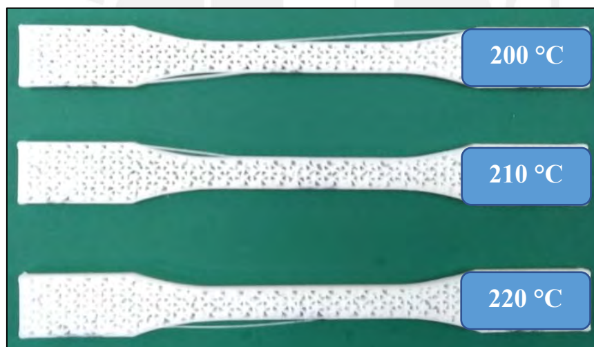
Figura 30 Mala adhesión de los contornos al imprimir ABS hasta 200 °C, con patrón triangular, 60 mm/s de velocidad y 0.2 mm de altura de capa.
