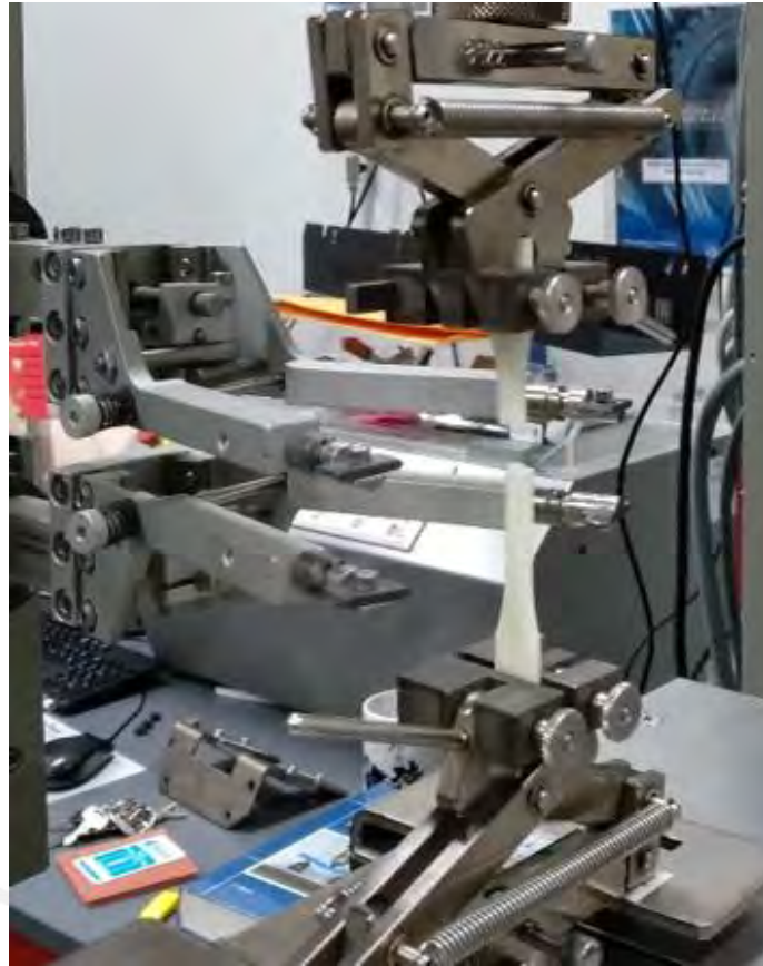
Figura 38 Prueba de rotura en la zona calibrada usando el equipo Zwick/Roell Z050.
