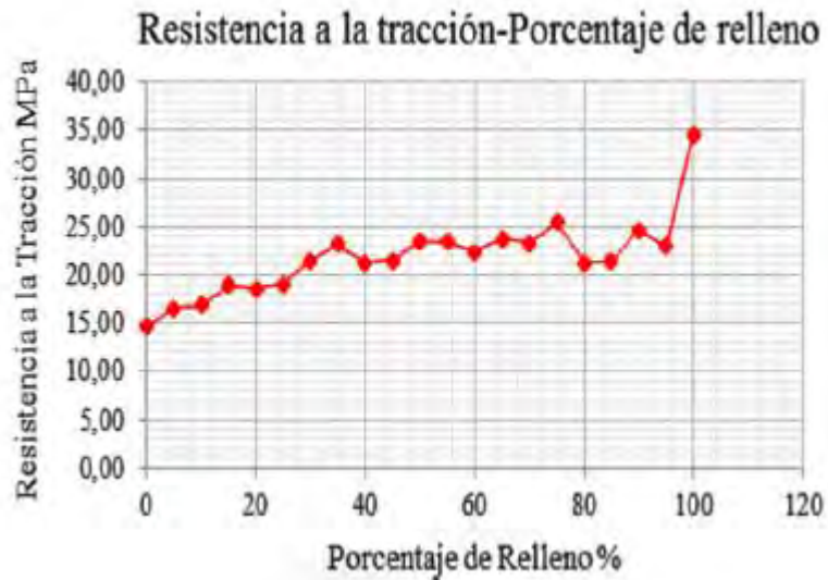
Gráfico 2 Resistencia a la tracción- porcentaje de relleno. [Tomado de Álvarez, 2016].
