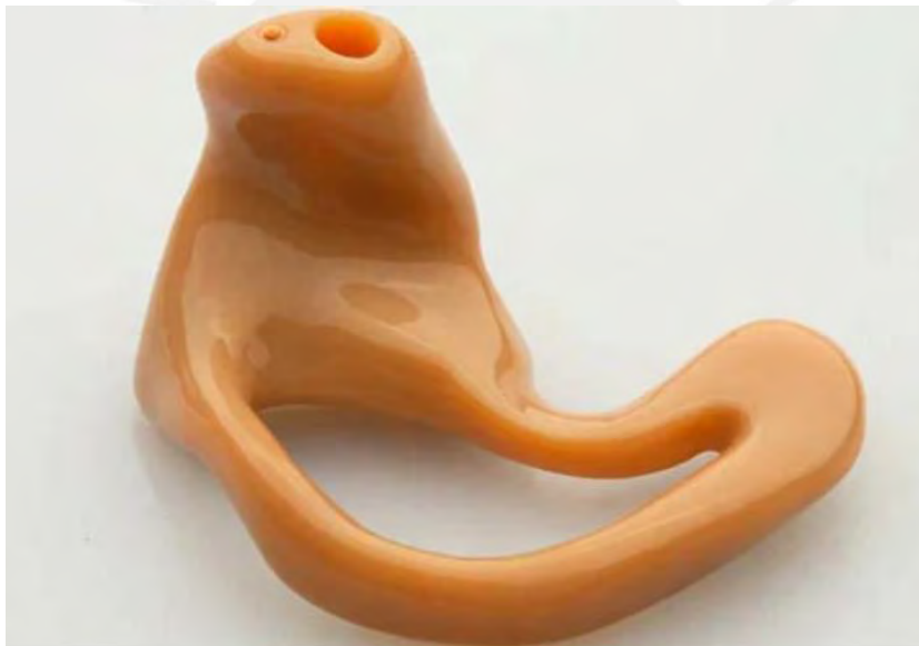
Figura 9 Muestra de audífonos personalizados impreso por la empresa Envision TEC [Contreras, 2018].
