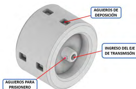
Figura 4.28: Disco difusor de semillas (imagen propia)
