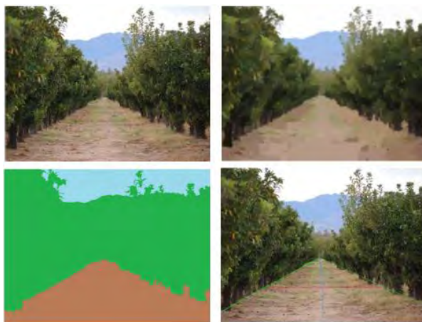
Figura 6.7: Procesamiento de imagen para navegación (Blok et al. , 2019)
