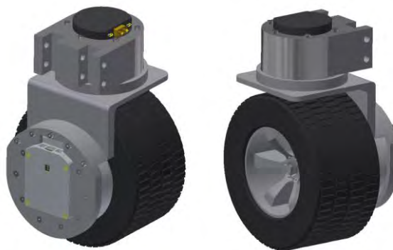
Figura 4.12: Vistas isométricas del ensamble hasta el segundo grado de libertad (imagen propia)
