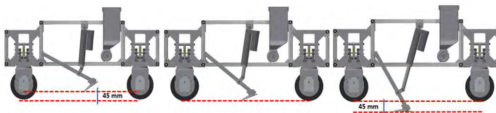
Figura 4.38: Funcionamiento del mecanismo de labrado (imagen propia)
