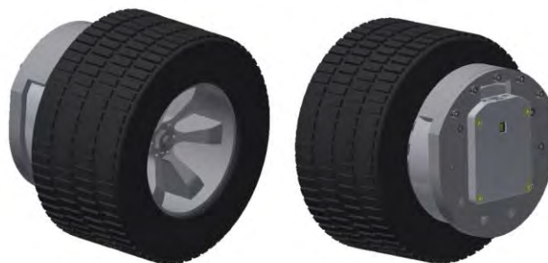
Figura 4.8: Vistas isométricas del ensamble rueda-carcasa-motor (imagen propia)
