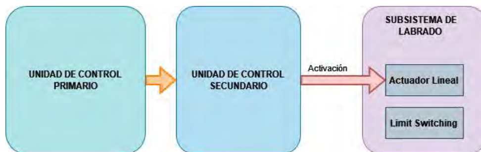
Figura 6.11: Lazo de control del subsistema de labrado (imagen propia)
