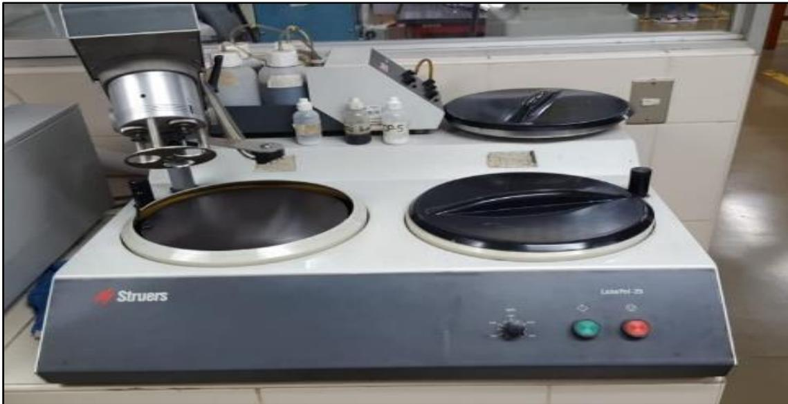
Figura 32. Discos para acabado fino con pasta de diamante de la Marca “Struers”.
