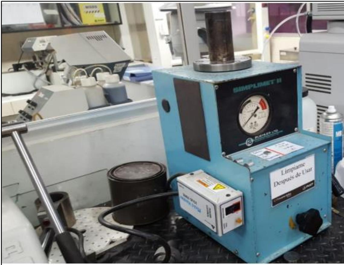
Figura 31. Máquina de fabricación de briquetas modelo modelo “SimpliMet II” marca “Buehler”, usado en este análisis de falla.
