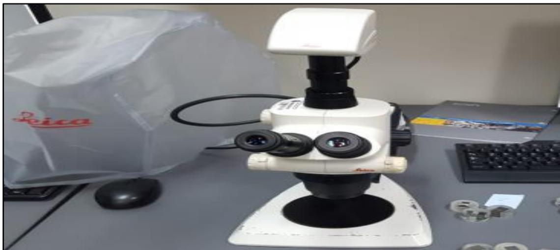
Figura 30. Estereoscopio modelo “S6D” de la marca “Leica” usado para realizar la inspección de muestras hasta con aumentos de 50X.
