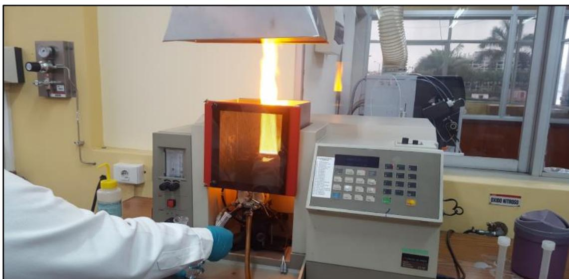
Figura 41. Espectrometro de absorción atómica usado en el análisis químico
