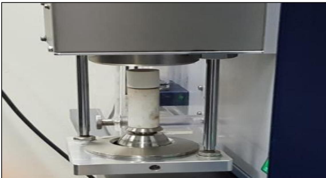
Figura 40. Base cerámica que sostiene al crisol y por medio del cual se introduce en el horno.
