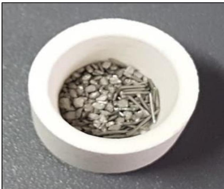
Figura 38. Probeta para el analizador de carbono con el gramo de alambre cortado y el catalizador a base de tungsteno.
