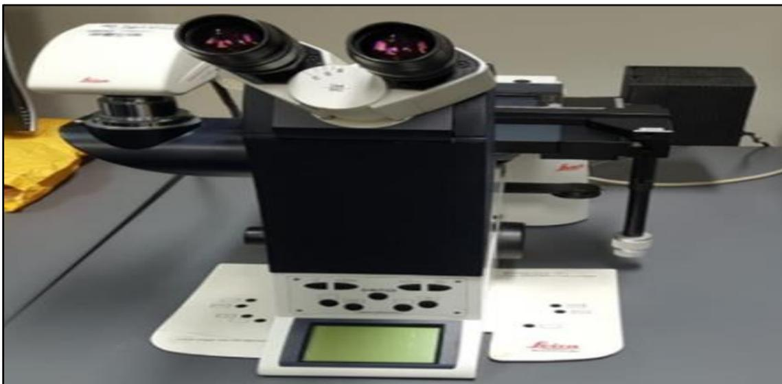
Figura 33. Microscopio modelo “DMI 5000” de la marca “Leica”, con aumentos de 50 a 1000 usado en el ensayo de metalografía.
