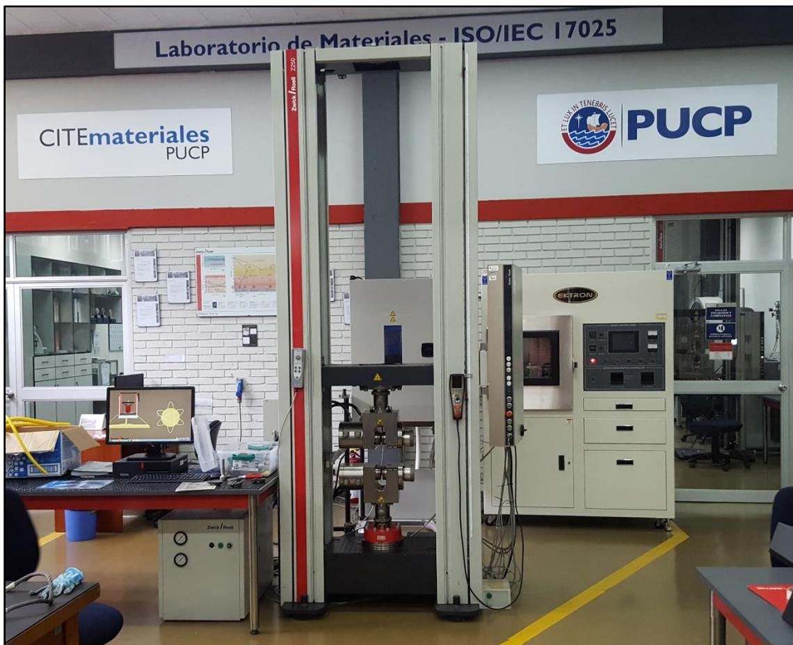
Figura 35. Máquina de ensayo de tracción Marca Zwick/Roell, modelo Z 250.
