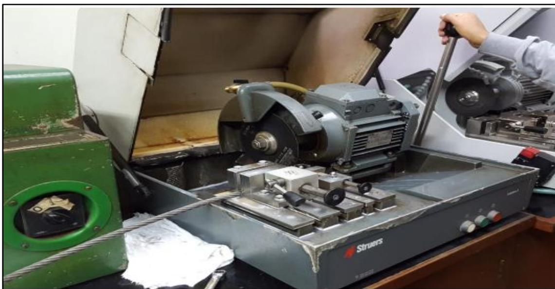
Figura 29. Cortadora de disco “Labotom-5” de la marca “Struers” usado en la extracción de muestras de los segmentos del cable.
