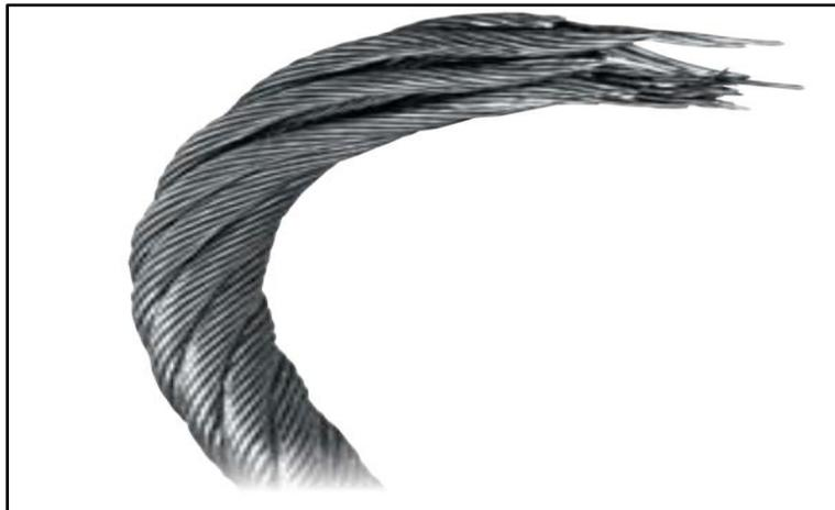
Figura 21. Fractura de un rizo que se da cuando intenta pasar por la polea
