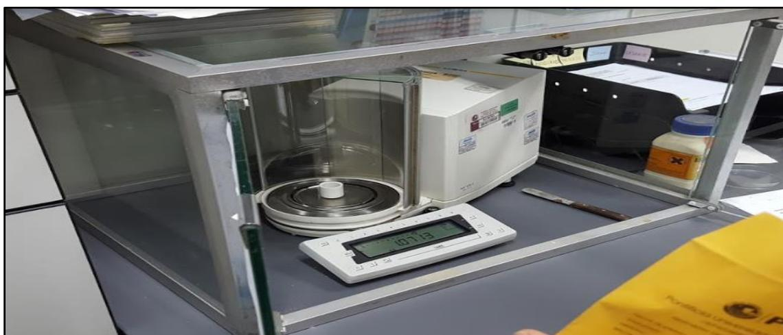
Figura 37. Balanza electrónica con la cual se pesaron los crisoles.
