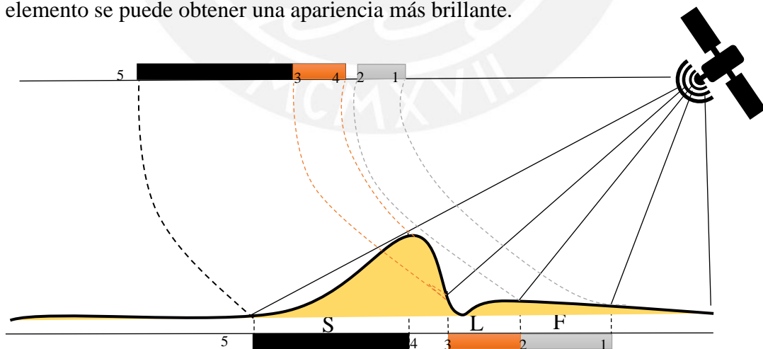
Figura 15: Efectos geométricos en una imagen SAR. La letra “S” denota el Shadowing , la letra “L” denota el Layover y la letra “F” denota el Foreshortening
