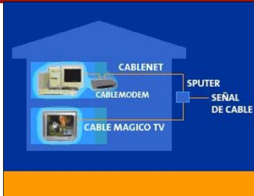
Figura 1: Esquema de la red de acceso Cable MODEM.
