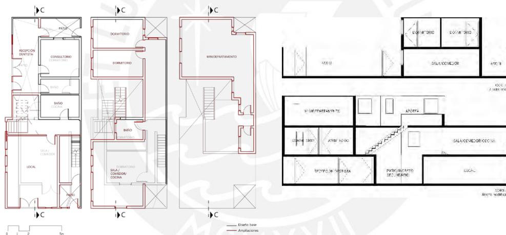
[Figura 9] Izquierda: Planos base de la vivienda elegida con ampliaciones. Derecha: Cortes del diseño inicial y actual.
