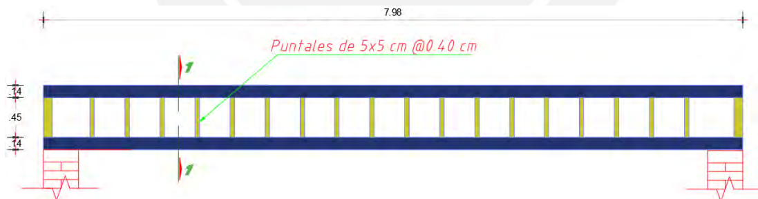
Figura 4.15 Tijeral de la cumbrera del techo de local comunal de Orcopampa
