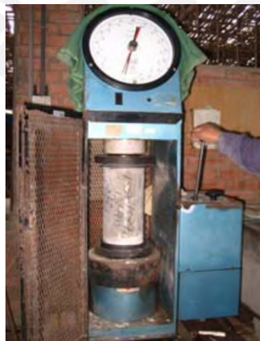
Figura 3.6 Ensayo a compresión de probetas de concreto
