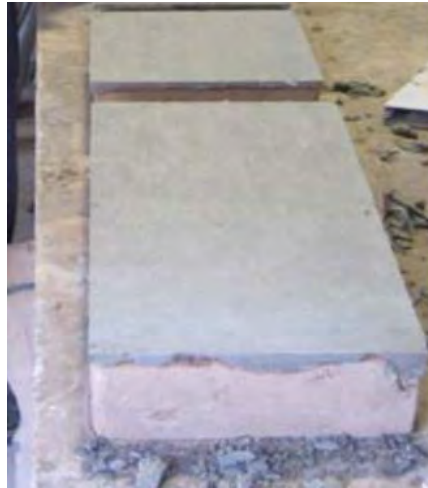
Figura 3.3 Ensayo a compresión del adobe
