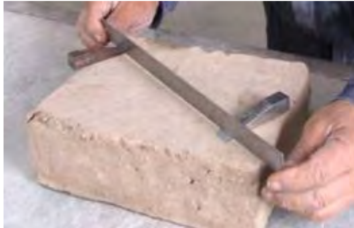
Figura 3.2 Ensayo de alabeo
