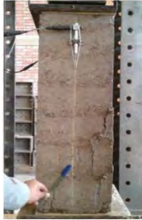
Figura 3.4 Ensayo de compresión a muro de adobe
